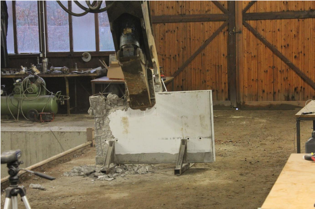
Abbildung 15: Dritte Versuchsreihe: Pressschneiden von Stahlbeton
