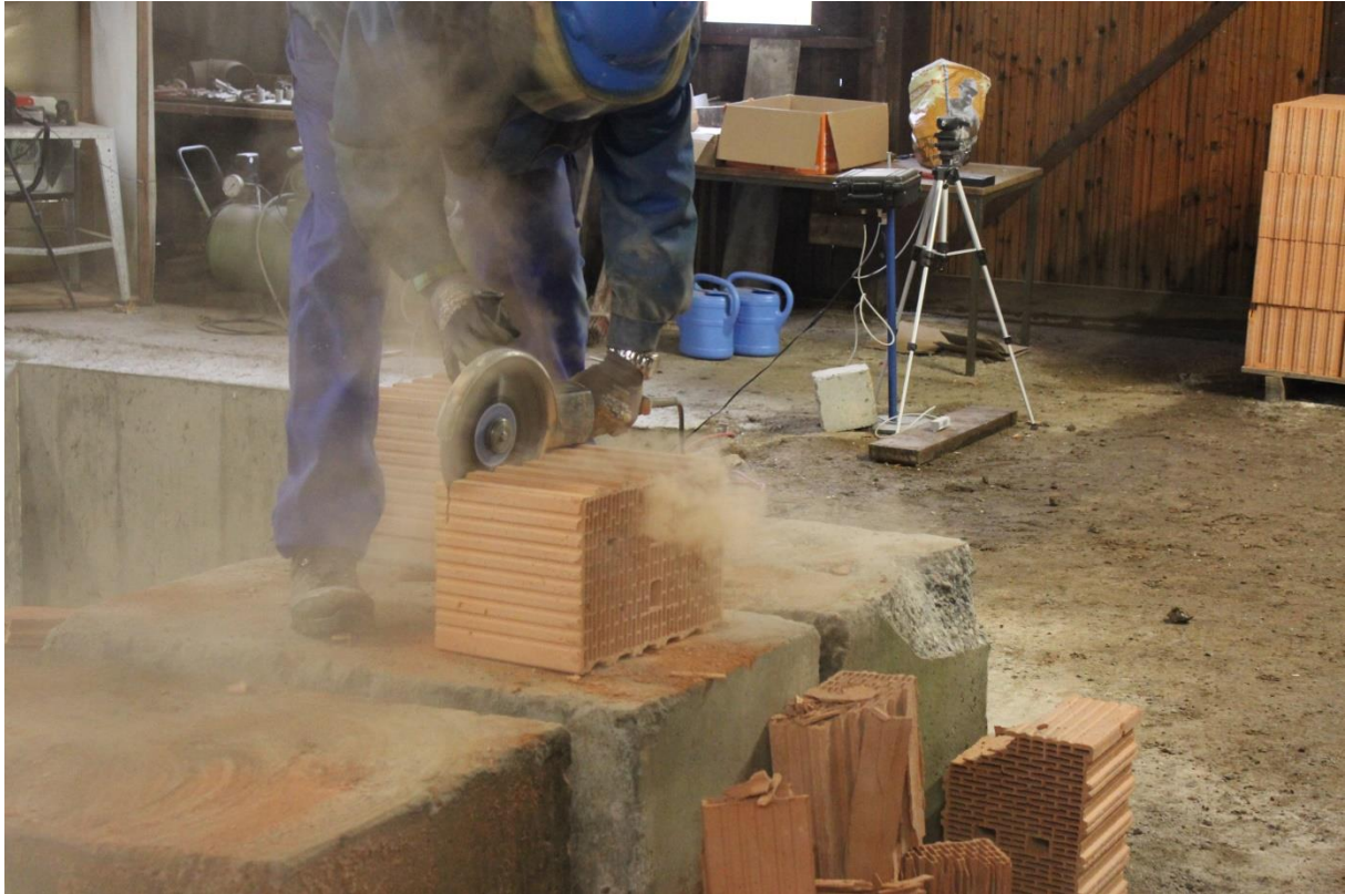
Abbildung 14: Erste Versuchsreihe: Sägen von Ziegelmauerwerk
