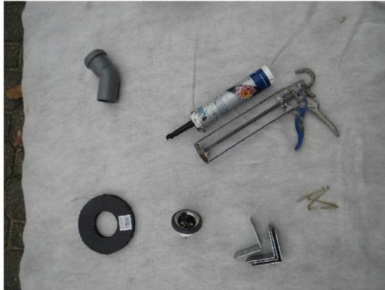
PE-Bogen (DN 50), Folienkleber (mit Klebepistole), Holzschrauben, Stahlwinkel, Abfluss, Lochband
