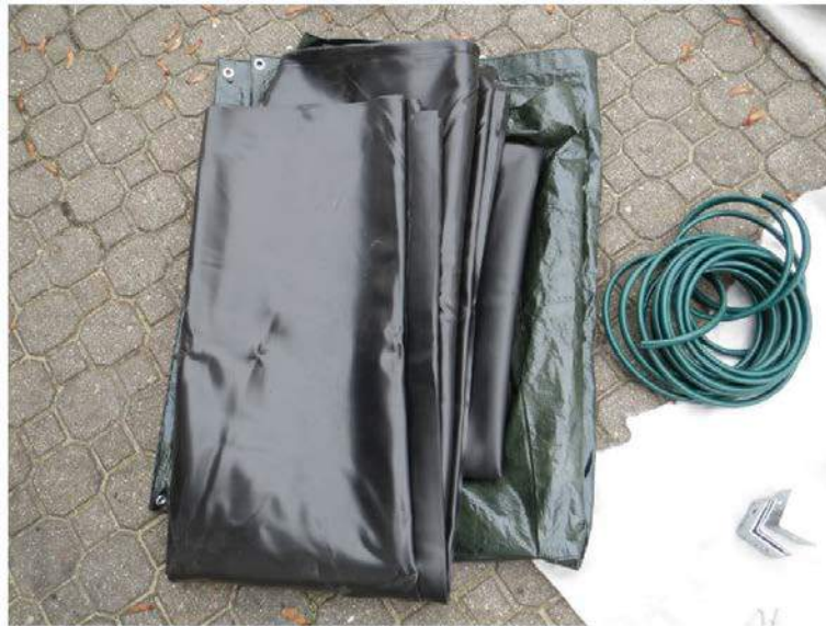
PVC-Teichfolie (1 mm), Gewebeplane, Gartenschlauch (1/2 Zoll), Stahlwinkel
