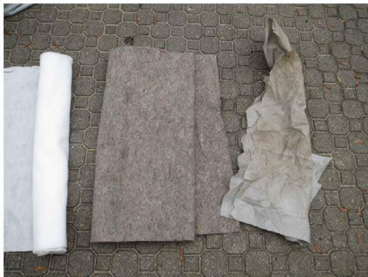
Bau- und Filtervliese 500 g/m 2 , 1000 g/m 2 und 150 g/m 2
