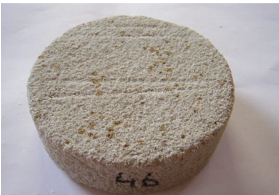
Bild 21: Punktförmige, braune Farbveränderungen der Oberfläche des Probekörpers nach der H 2 O 2 Behandlung
