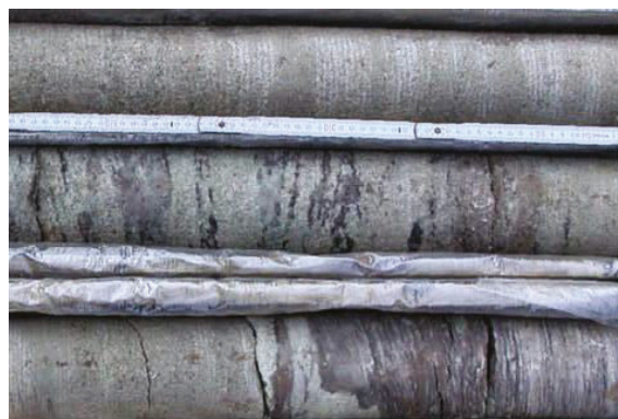
Bild 7: Bohrkerne - Schrägschichtung aus Lindenfirstbohrung [Quelle: RP Stuttgart, Bung]
