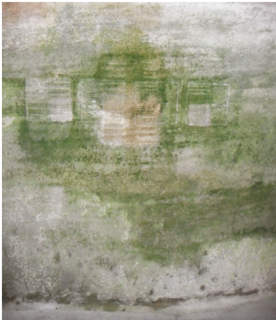
Bild 25: UV-bestrahlte Musterfläche, grauen Streifen (graue Pfeile): Probenahme vor Bestrahlung; grünen Streifen (grüne Pfeile): Probenahme nach UV Bestrahlung
