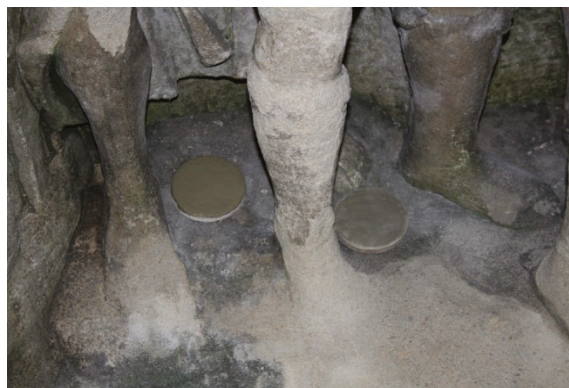
Bild 43: Zur Härtung am Objekt ausgelegte Probekörper mit Kittmasse
