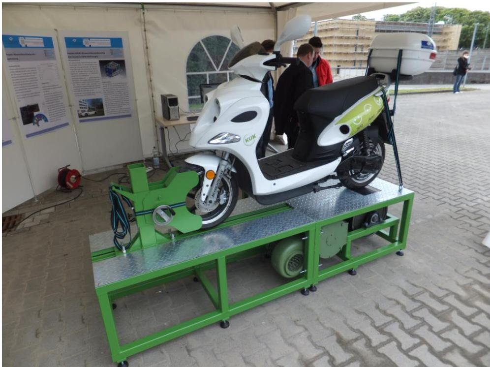
Abbildung 42: E-Roller Prüfstand
