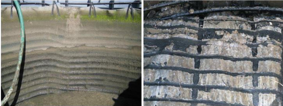
Abbildung 4-25: Mikrobielle Kolmation eines Geotextils [Lambert, 2011]
