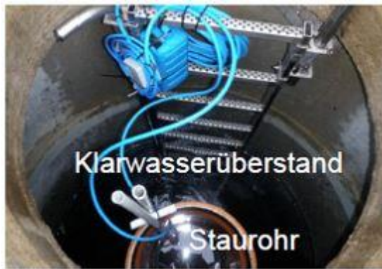
Abbildung 4-27: Autarke Wasserstandmessung zur Überwachung dezentraler Regenwasserbehandlungsanlagen [Hoppe, 2012]
