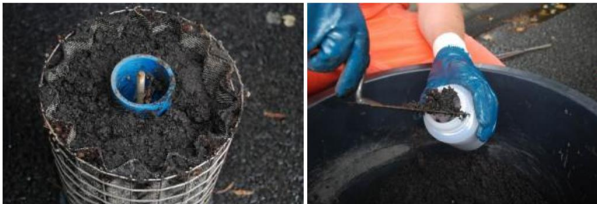
Abbildung 4-11: Probenahme INNOLET Filtermaterialien [SEH und IGS, 2010]
