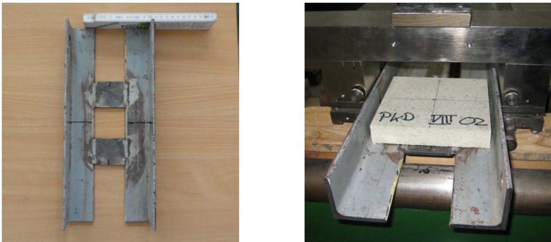
Abbildung 23 Modifizierte Werkstückaufnahme und eingebauter Prüfkörper
