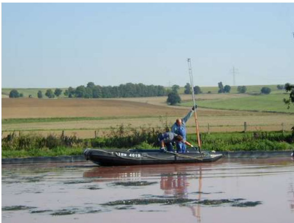
Fig. 6: Măsurarea nivelului de nămol într-un iaz preliminar
