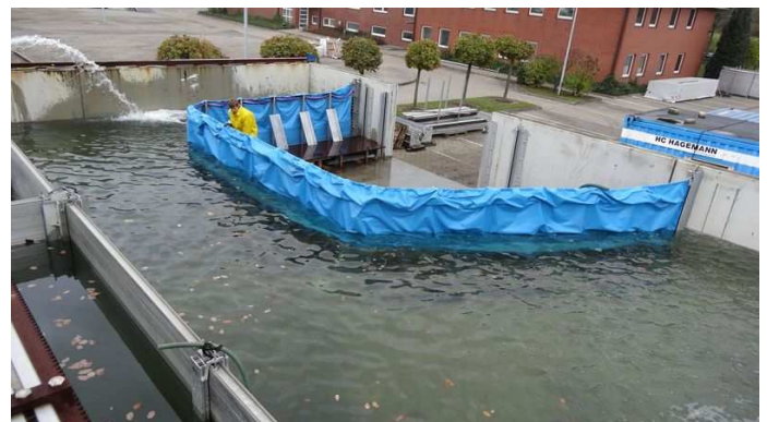
Bild: AquaWand in der Versuchsanlage
