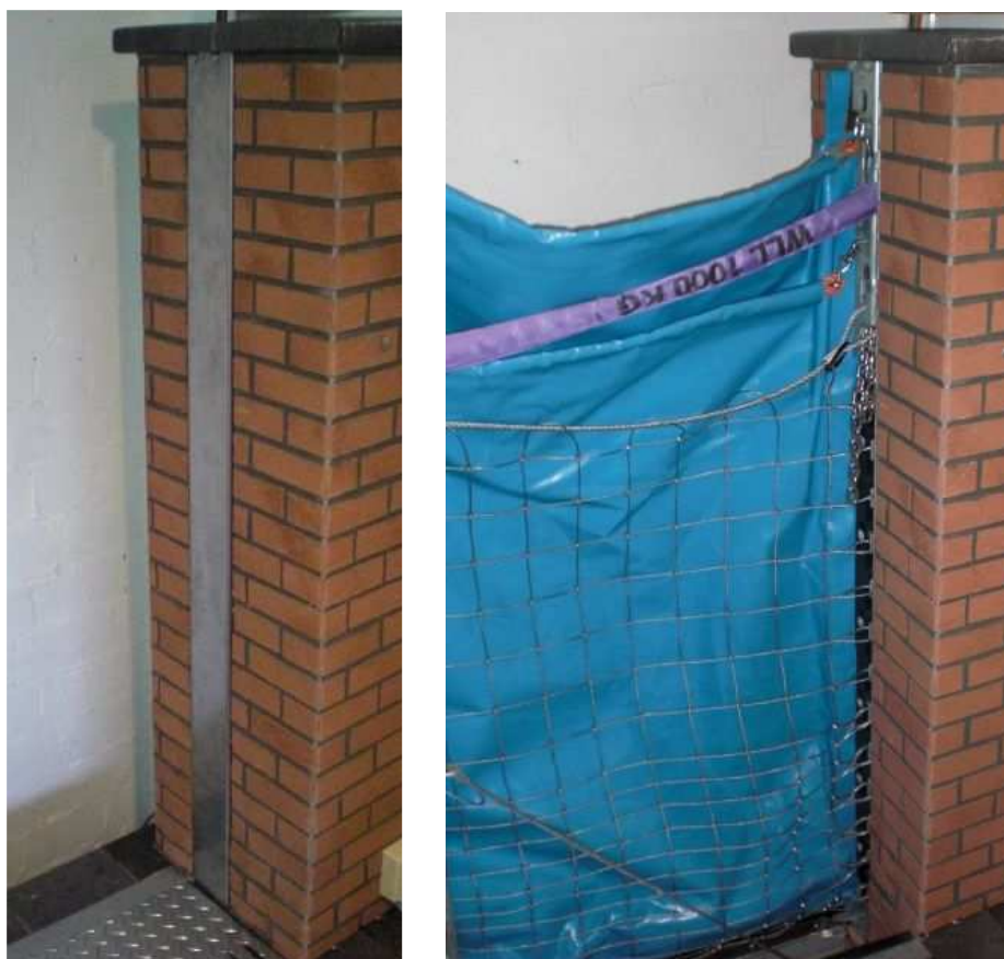
Abbildung 21: Der Wandanschluss geschlossen und mit Folie und Netz
