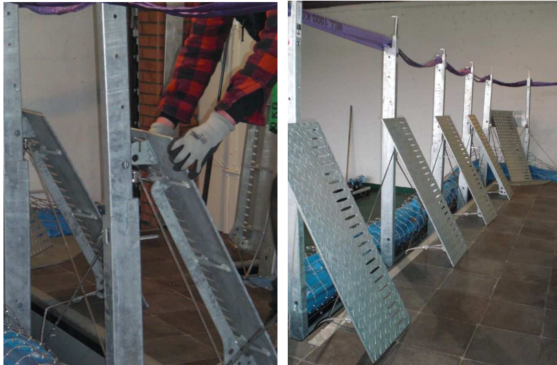
Abbildung 15: Deckel und Pfosten werden verbolzt
