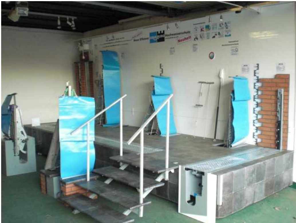
Abbildung 1: Das Funktionsmodell der AquaWand in den verschiedenen Stauhöhen
