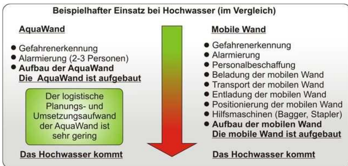
Abbildung 26: Vergleich AquaWand / Mobile Wand
