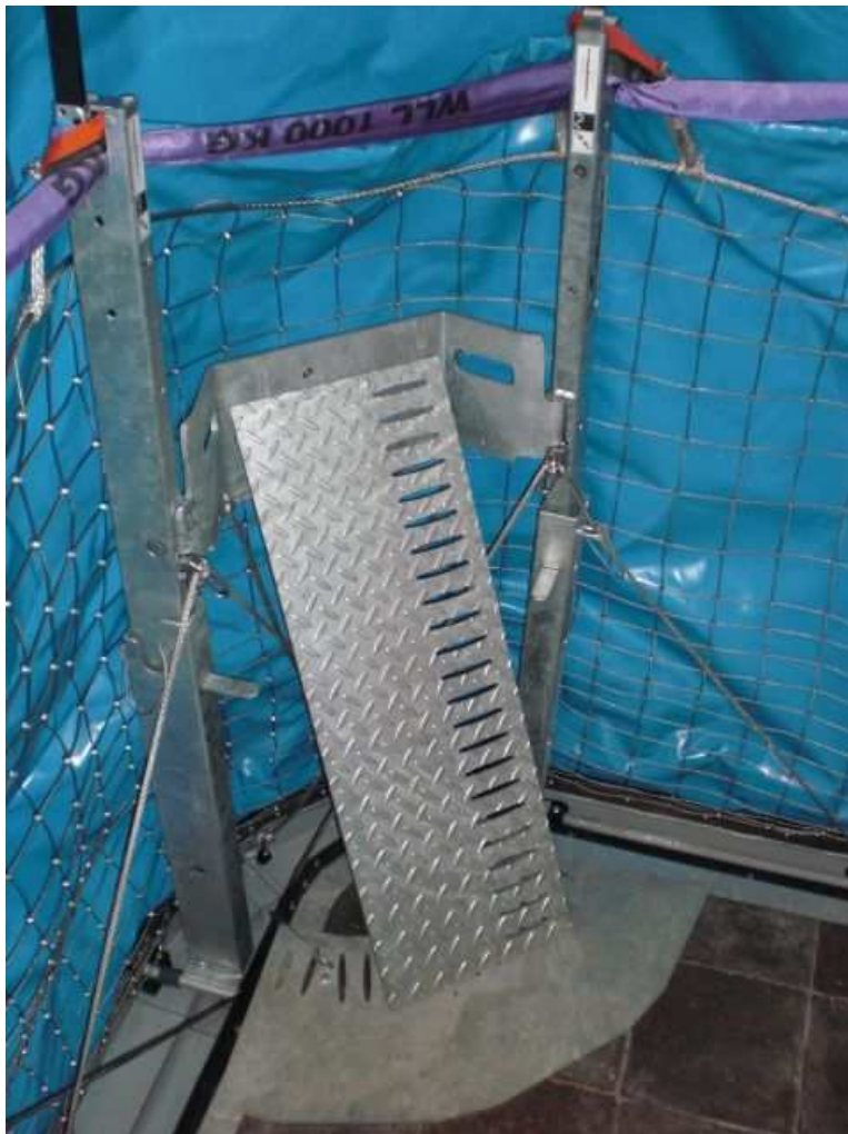
Abbildung 24: Die Ecke der AquaWand im aufgebauten Zustand
