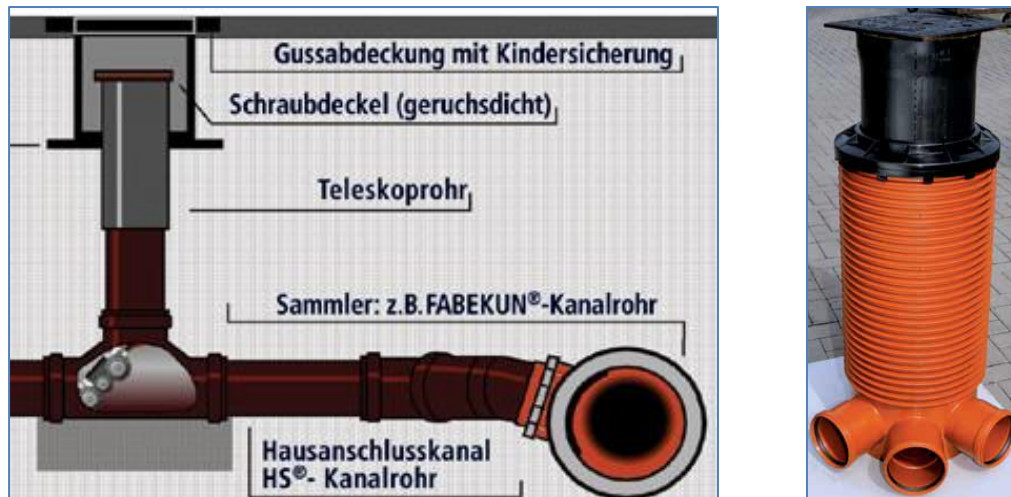
Abbildung 10: Prinzip der Anordnung einer Revisionsöffnung (Quelle: Fa. Fabekun)
