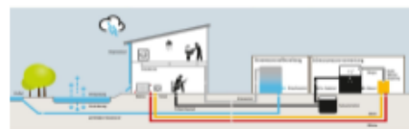
Der HAMBURG WATER Cycle® zur Trennung und Nutzung häuslicher Abwässer (Quelle: HAMBURG WASSER)
