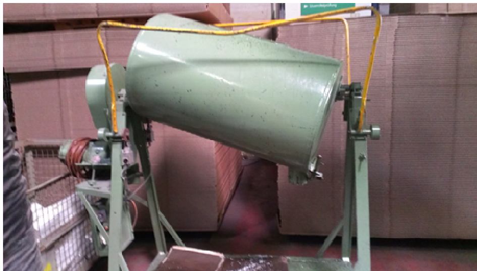
Abbildung 6: Verwendeter Taumelmischer zur Weichmacherdosierung
