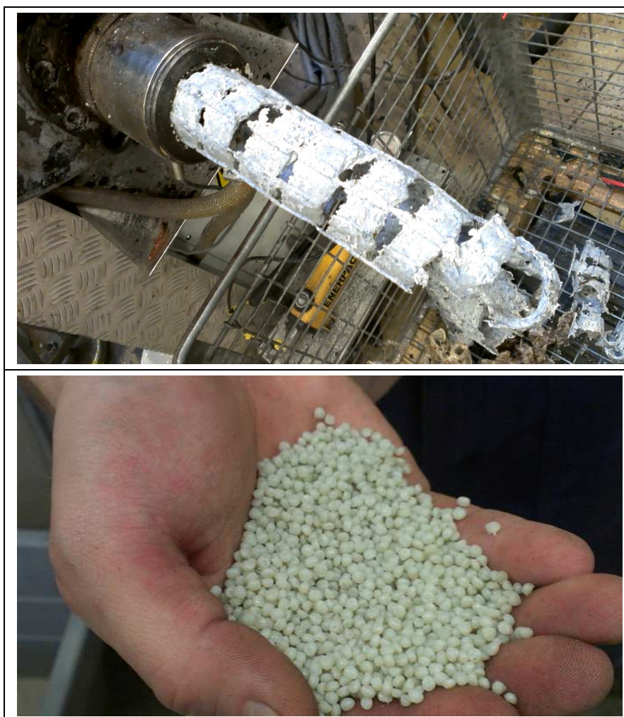
Abbildung 7: Filter-Reject (oben) und filtriertes Granulat (unten)
