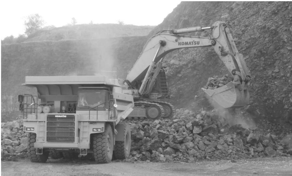
**Abbildung 4:** Hydraulikbagger während der Messungen bei der SKW-Beladung auf Zwischenstufe
