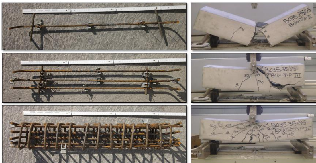
Bild 78 Ausgeführte Bewehrung der hergestellten Balken und exemplarische Balkenprüfung für Typ II, III und IV
