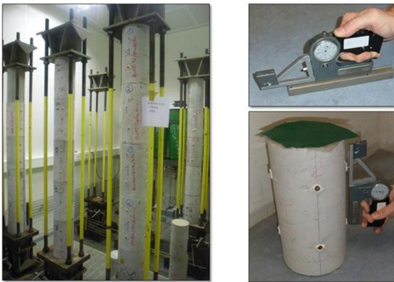
Bild 35 Aufgebrachte Kriechspannungen und Versuchsaufbau zum Kriechverhalten (links) Schwindmessung (rechts unten)
