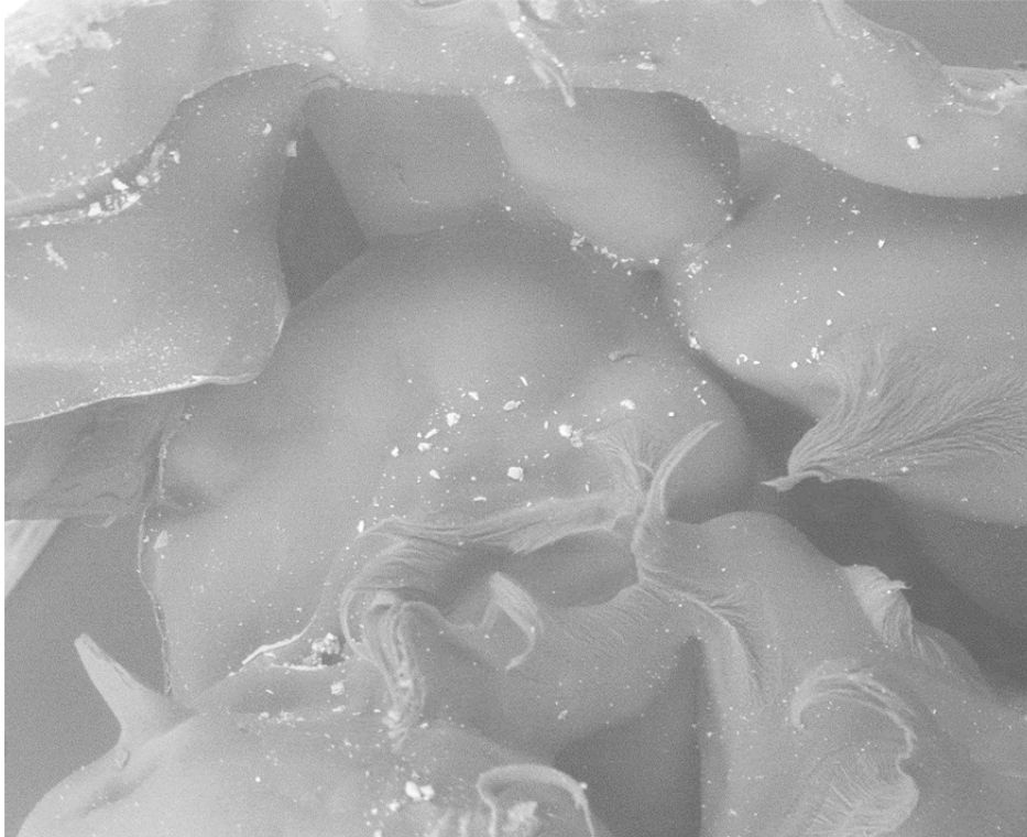
Filtertyp C nach 72 stündiger Durchströmung von hochmineralisiertem 10°C warmen Fluid
