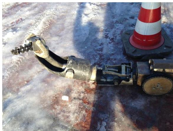
Bild 20: Inspektionseinheit „Lindauer Schere“ im Inspektionsfahrzeug der Fa. Meyer-Entsorgung.
