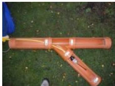
Bild 43: 45°-Abzweig wird entgegen der Fließrichtung passiert.
