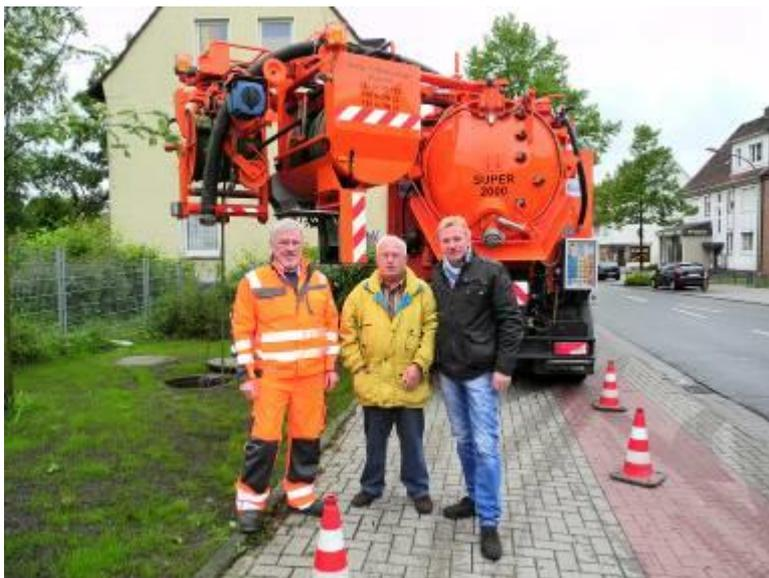
Bild 80: Hochdruckspülwagen ausgestattet mit der „Sehenden Nordseedüse“
