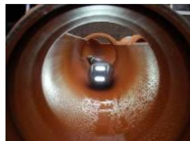
Bild 79: Lage des Kamerakopfes im Rohr.
