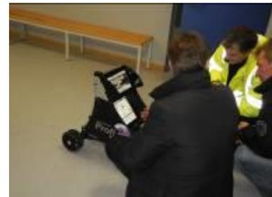
Bild 61: Kontrolle des Leitungsverlaufs im Gebäude
