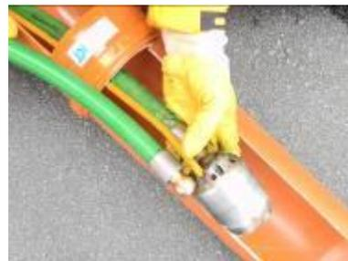
Bild 82: Kugelkopf zum Anschluss an den Spülkopf mit Kamera. HD-Schlauch (grün). Datenkabel (gelb).
