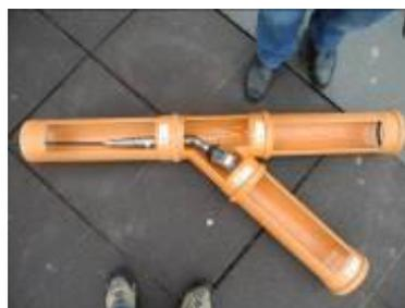
Bild 78: 45°Abzweig wird entgegen der Fließrichtung passiert
