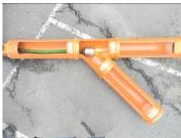
Bild 84: 45°Abzweig wird entgegen der Fließrichtung passiert
