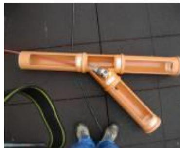
Bild 49: 45°-Abzweig wird von der AGILIOS PTP70 entgegen der Fließrichtung passiert
