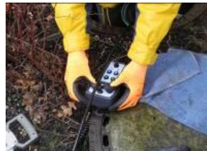
Bild 69: Steuerung für die Abbiegefähige Inspektionsvorrichtung.
