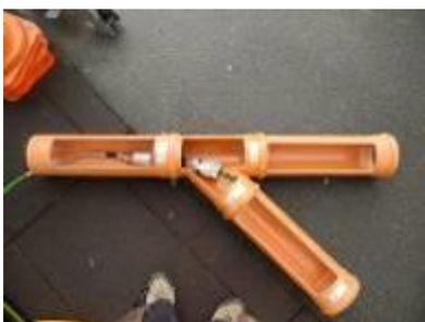
Bild 56: Vorversuch zur Abbiegefähigkeit
