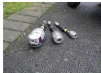
Bild 65: Unterschiedliche aber nicht abbiegefähige Kameraköpfe für das CamMobil Profi 3-System.
