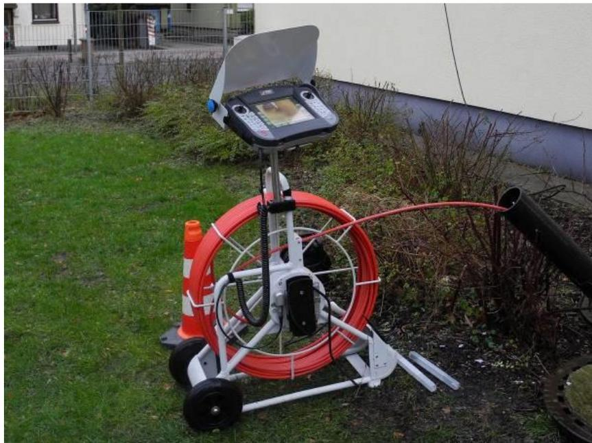
*Bild 18: Inspektionsgerät Agilios mit Bedienpult VISIONCONTROL VC200. Einsatzort: Entwässerungsnetz der Turnhalle der Heiligenwegschole in Osnabrück.*
