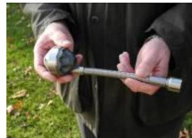
Bild 36: Reinigungsdüse mit flexiblem Adapter-
