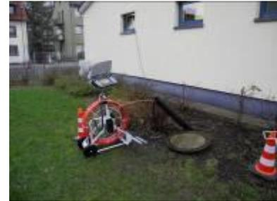
Bild 46: Einsatzbereite Inspektionseinheit kurz vor der Inspektion
