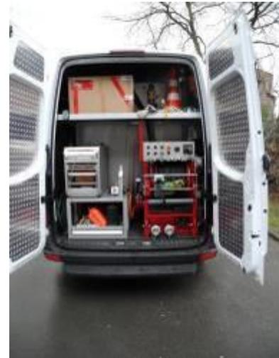
Bild 47: Weitere Ausstattung des Inspektionsfahrzeuges, insbesondere mit einer separaten Hochdruckspüleinheit.
