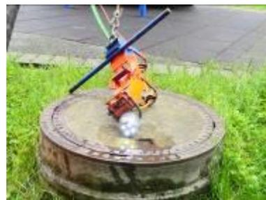
Bild 81: Kamerakopf im Geschirr zur Umlenkung des Hochdruckschlauchs im Schacht.
