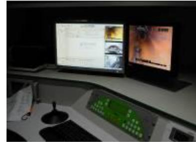
Bild 32: Steuerung und Zustandsdokumentation ausgehend vom Steuerstand im TV-Wagen
