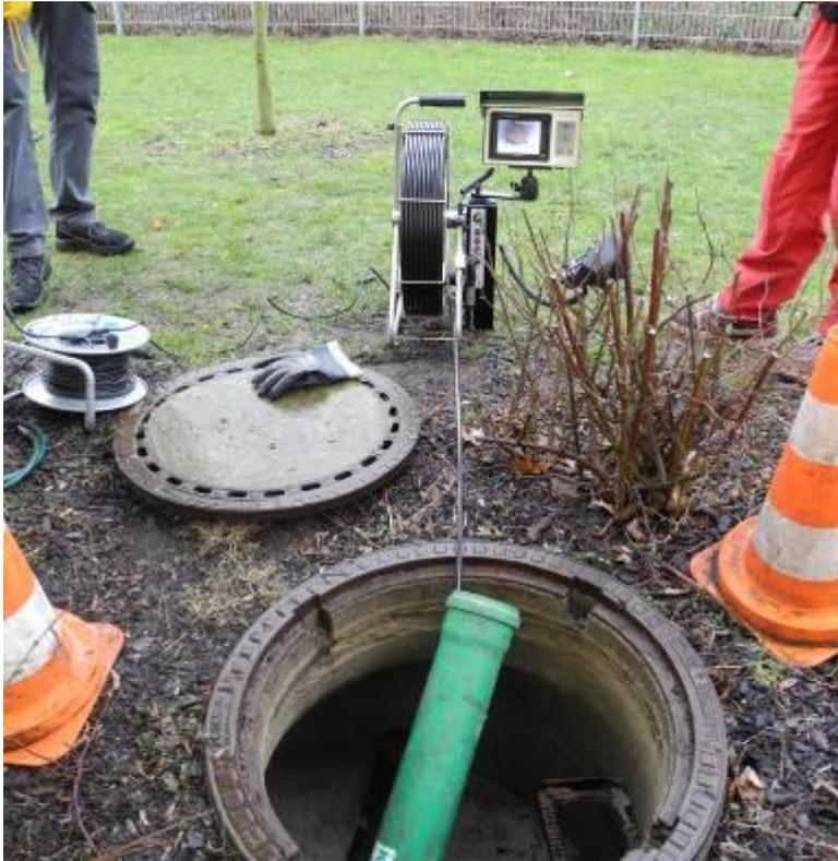
Bild 67: Einbringen der Kamera über ein KG-Rohr in den Revisionsschacht
