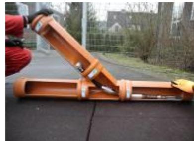
Bild 72: Inspektionskamera biegt in den nach oben gerichteten Abzweig ab.
