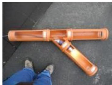
Bild 64: 45°Abzweig wird entgegen der Fließrichtung passiert
