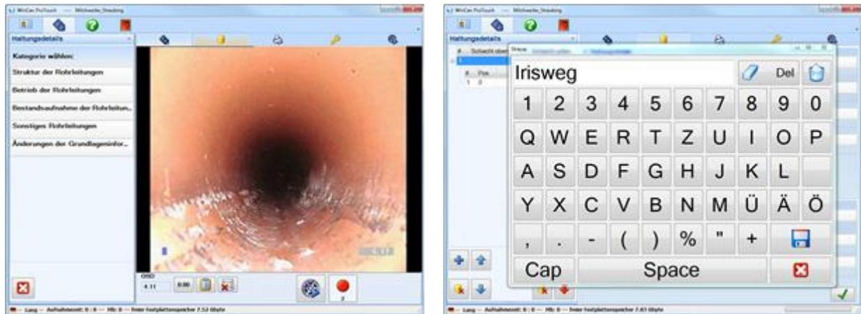
Bild 5: Bedienoberfläche der Inspektionssoftware WinCan ProTouch: **Links** Oberfläche mit Video-bild. **Rechts**: Eingabefeld mit extra großen Schaltflächen.
