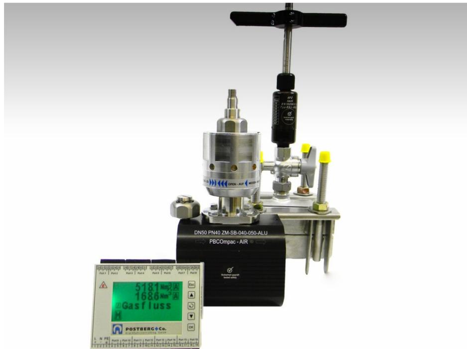
**Abbildung 17: Anbohrrohrschelle mit Rückschlagschutz (hinten), 40 bar MultiController und Sensorik (mitte) und passender Datenlogger mit RS485-Sensorschnittstelle und Druckkompensation (vorne)**
