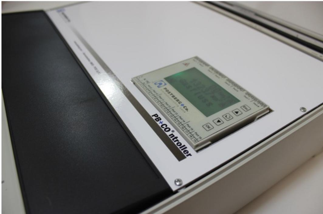
**Abbildung 18: Designtes Gehäuse und Basishardware mit notwendigen Ein- und Ausgängen für den CAE-Manager/PB+Controller**
