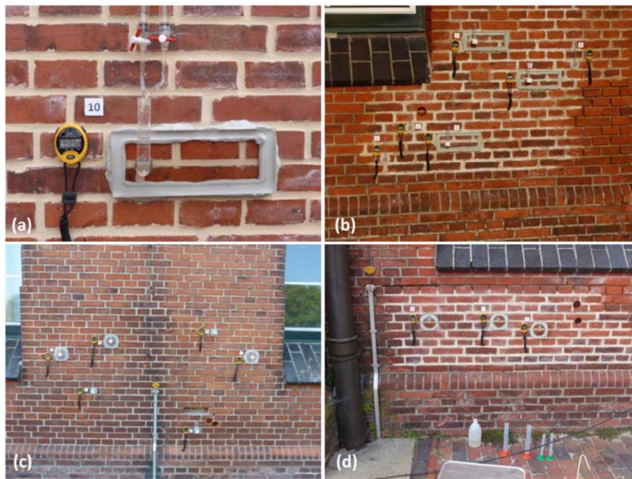
Abb. 61: Wasseraufnahmeprüfungen nach Fugenmörtelerneuerung mittels Franke-Platte und mittels großer Karsten-Platte. (a) Franke-Platte mit Bürette im Bauabschnitt 1; (b) Messungen in Musterfläche 3 (Übersicht, 20.11.2013); (c) Messungen auf der Ostseite mit kleiner und großer Karsten-Platte (Altbestand, gleiche Stelle wie Messungen mit Karsten-Röhrchen und Franke-Platte in Abb. 51a; (d) Messungen mit großer Karsten-Platte (Musterfläche 2).
