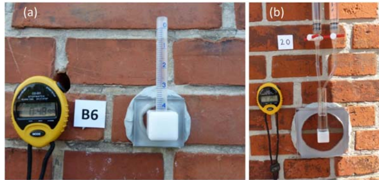
Abb. 5: (a) Vergrößerung der Messfläche des Wassereindringprüfers nach Karsten auf einen Durchmesser von 4 cm in Kunststoffausführung. (b) Statt der WA-Prüfplatte nach Franke wurde auf eine runde Karsten-Prüfplatte (Durchmesser 10 cm) zurückgegriffen, mit der die Wasseraufnahme sämtlicher gängiger Mauerwerksverbände und Ziegelformate gemessen werden kann; die Einfüllhöhe des Standrohres kann ebenfalls mit einer Doppelbürette auf der vorgesehenen Höhe gehalten werden.
