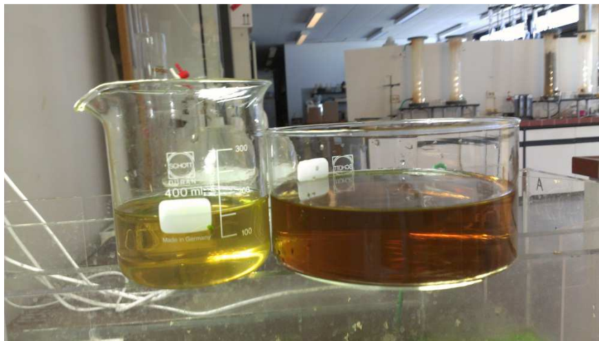
Abbildung II-74: Vergleich des Sickerwassers nach (links) und vor der Reinigung (rechts).
