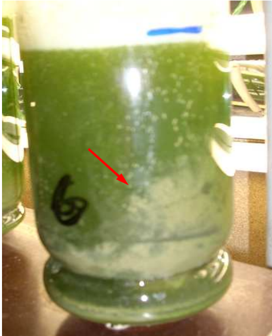
Abbildung II-50: Grauer Niederschlag am Reaktor.
