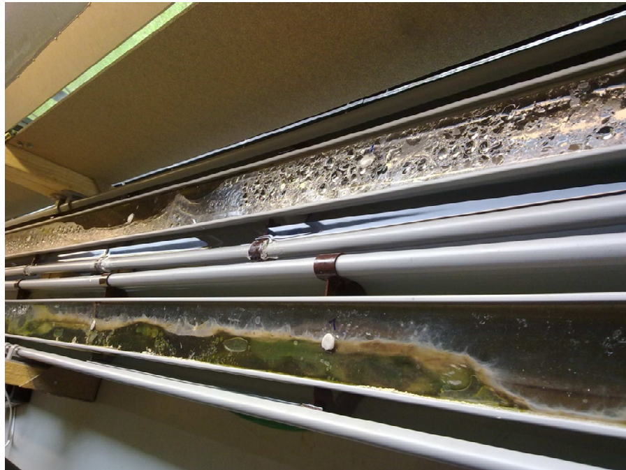
Abb 1: Kanalbildung in der Algenrinne im Labor des LWI
