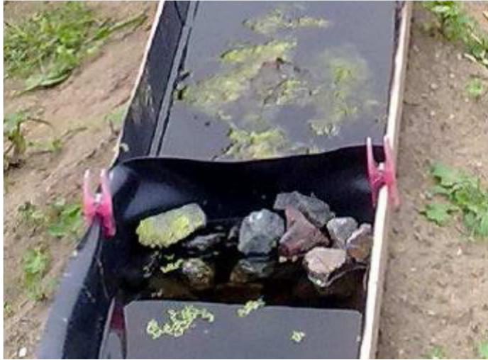
Abbildung II-13: Sieb aus Teichfolie und Kieselsteinen.
