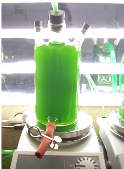
Abbildung II-10: Versuchsreaktor für den kontinuierlichen Betrieb.
