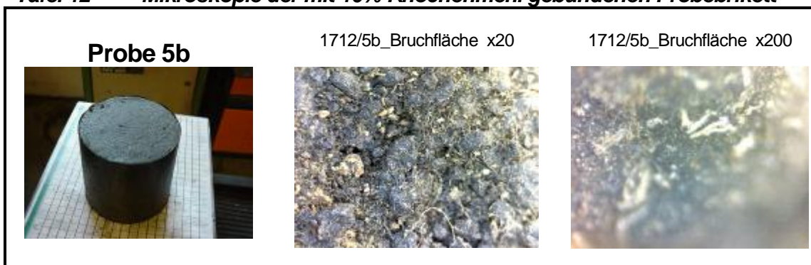
Tafel 12 Mikroskopie der mit 10% Knochenmehl gebundenen Probekbrikett
