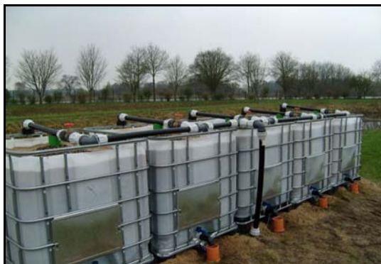
Abbildung 7: Lysimeteranlage mit Beschickungs- und Ablaufsystem
