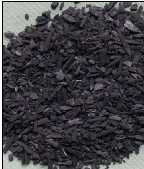
Abbildung 3: hochporöse Pflanzenkohle mit einer Körnung von 2 – 10 mm (gesiebt)
