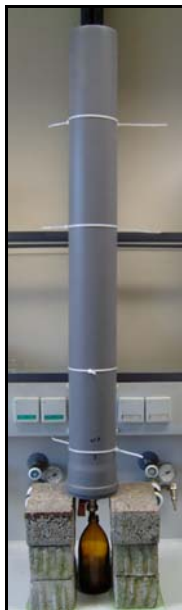
Abbildung 11: kleinskalige Filtersäule mit einer Länge von 100 Zentimeter; mit bodenseitigem Auslasshahn und Probensammelgefäß
