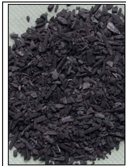
Abbildung 3: hochporöse Pflanzenkohle mit einer Körnung von 2 – 10 mm (gesiebt)
