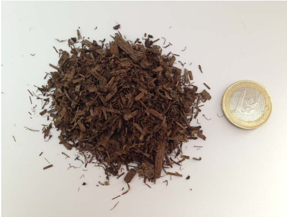
Abbildung 4: Gärprodukte nach erfolgreicher Ammoniak-Entfernung, Separierung und Trocknung im Größenvergleich zu einer Münze
