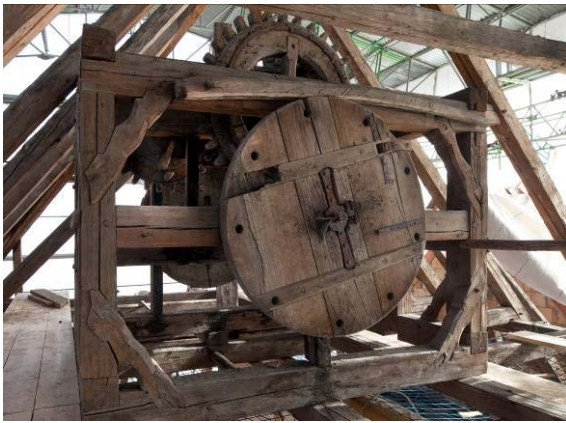
Bild 7: Hölzerne Winde im Dachraum des Kopfbaus, Foto: Uwe Gaasch.
