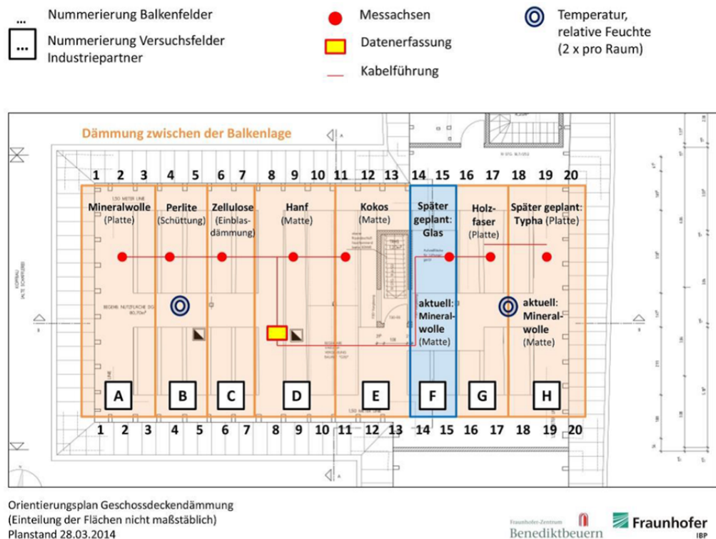
Bild 32: Orientierungsplan Dämmmaterialien in der obersten Geschossdecke.
