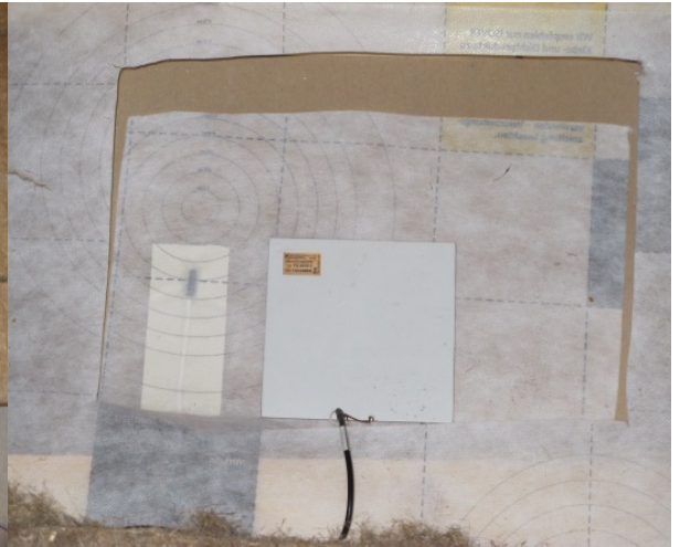
Bild 60: Wärmefluss-scheibe auf der Dämmebene fixiert.
