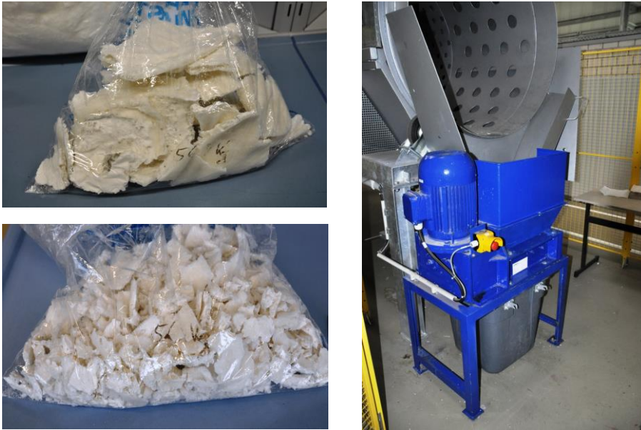
Abb. 36: BNC/PLA-Masterbatch vor (oben) und nach (unten) der Verarbeitung im Brecherwerk (links)
