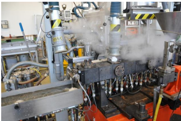
Abb. 32: Entweichen von Wasserdampf und Material
