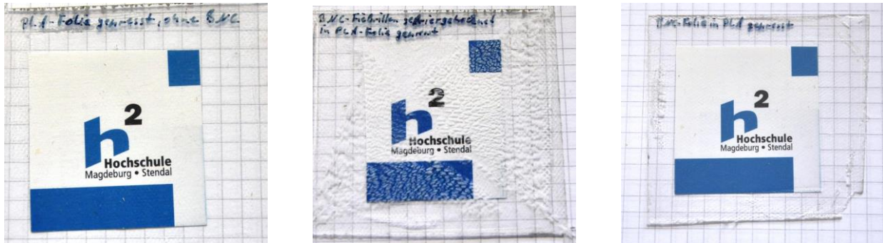
Abb. 20: Transparenz von PLA-Folien (v. l. n. r. ohne BNC, BNC-Fasern, BNC-Folie)
