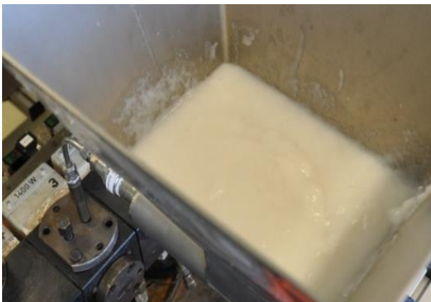
Abb. 29: Durch Zugabe von Methylcellulose stabilisierte BNC-Dispersion in der Dosiervorlage
