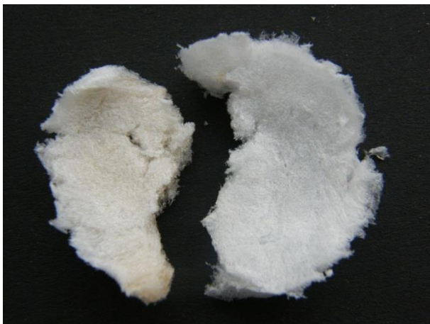
Abb. 4: Temperaturstabilität von gefriergetrockneten BNC-Fasern (Länge 0,125 mm) bei 300°C (links) im Vergleich zu 200°C (rechts)
