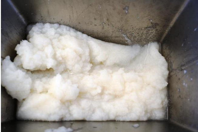
Abb. 28: Entwässerung der BNC-Dispersion in der Dosiervorlage
