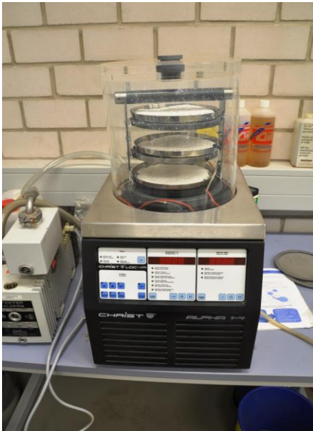
Abb. 33: Gefriertrocknung von BNC
