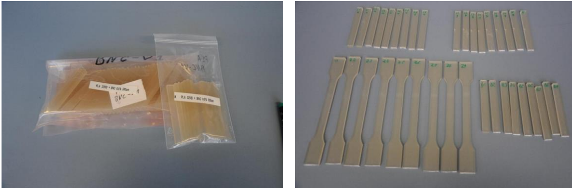
Abb. 40: Normprüfkörper aus BNC-verstärktem PLA
