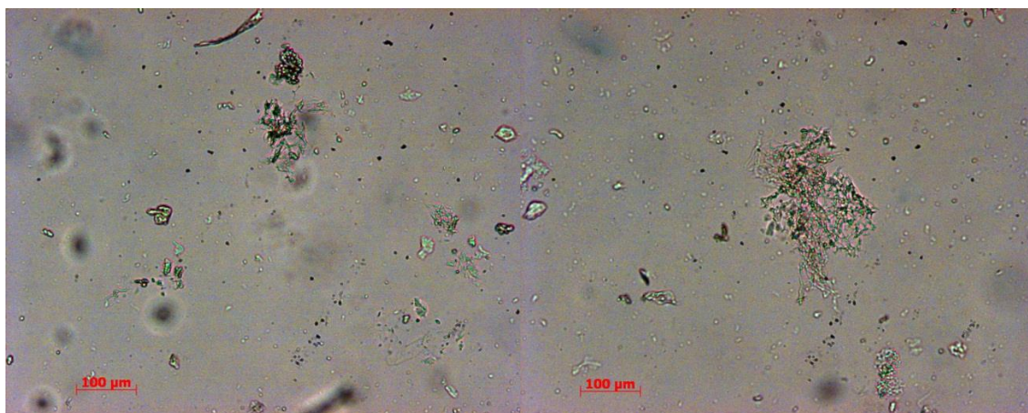
Abb. 9: Acetylierte BNC-Fasern nach Ultraschall-Behandlung
