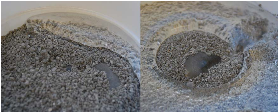
Abb. 3-5 Hydrophobes Aerogelbetonrezyklat bildet eine deutliche Trennschicht zu Wasser aus
