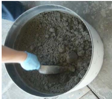
Abb. 4-7 Aerogelbeton mit 75 Vol.% Aerogelanteil
