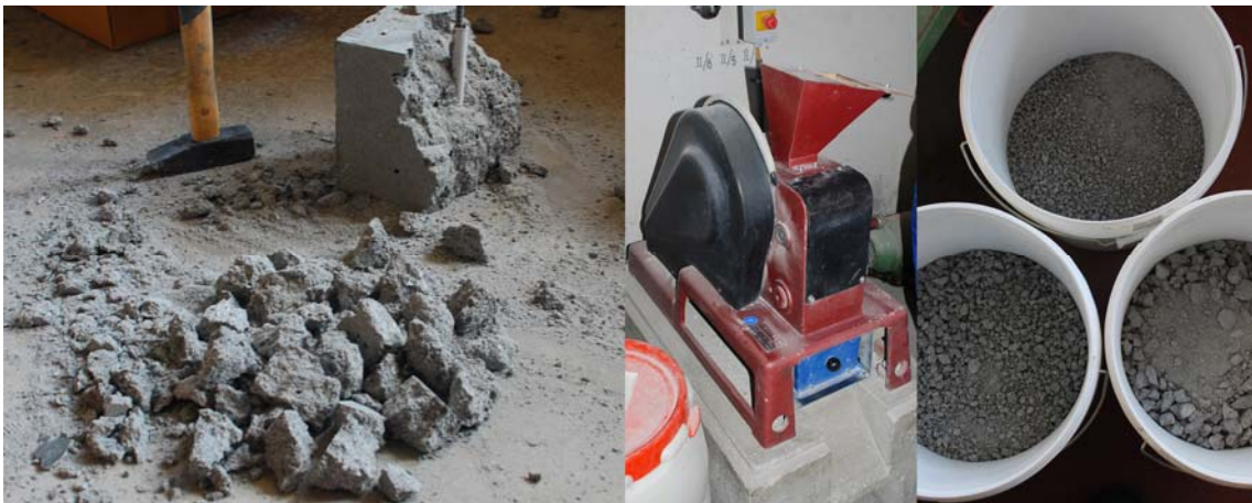
Abb. 3-1 Simulation Bauwerksabbruch - Zerkleinern im Laborbackenbrecher - drei unterschiedliche Kornzusammensetzungen des Materials
