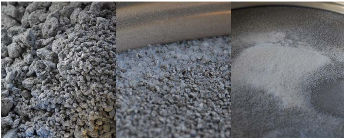
Abb. 3-3 Betonrezyklat mit zunehmender Trennquote für kleinere Korndurchmesser – Kornband 16 – 2,3mm (links), Siebrückstand bei 2mm (Mitte) und 1mm (rechts) Maschenweite
