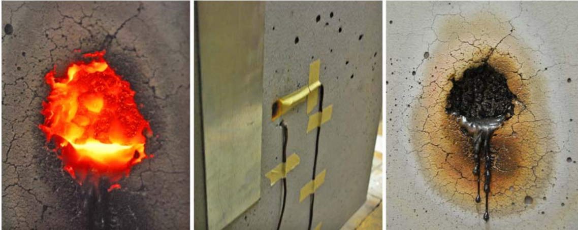
Abb. 5-8 Aerogelbetonschmelze unmittelbar nach Versuchsende - Klebeband auf der Rückseite des Probekörpers - ausgekühlte Schmelze
