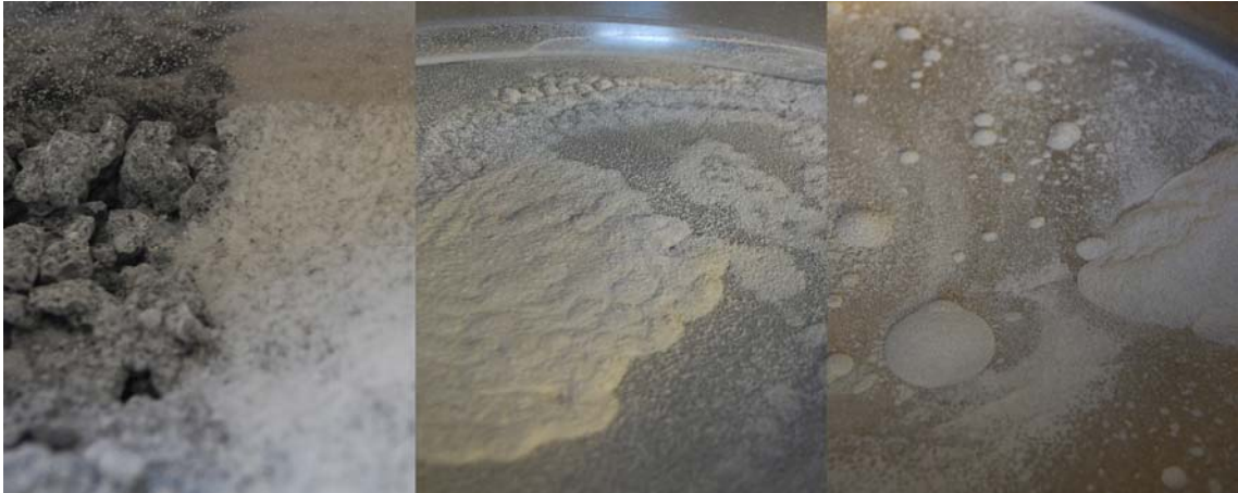
Abb. 3-4 zunehmender Anteil an gelösten Aerogelfeinstpartikel lässt das Rezyklat sich wie eine Flüssigkeit verhalten – Kornband 16–0,5mm (links), Siebrückstand bei 0,25mm (Mitte) und 0,125mm (rechts) Maschenweite
