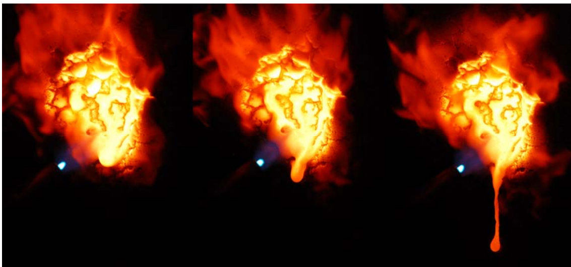
Abb. 5-7 Abtropfen der Schmelze (nach Versuchsdauer 20 Minuten)
