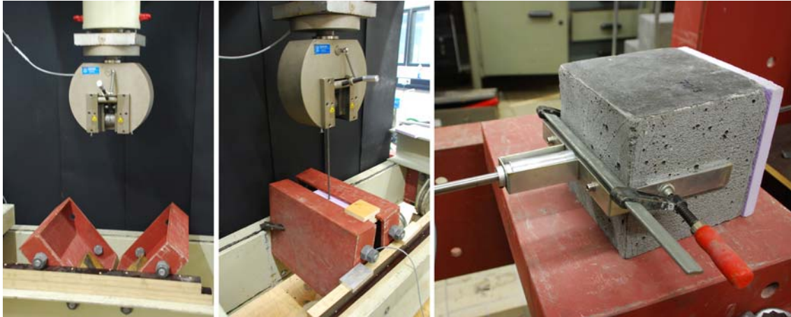
Abb. 5-9 Prüfanordnung Verbundverhalten mit eingebauten Probekörper (Mitte) - Probekörper mit Wegaufnehmer am unbelasteten Bewehrungsende
