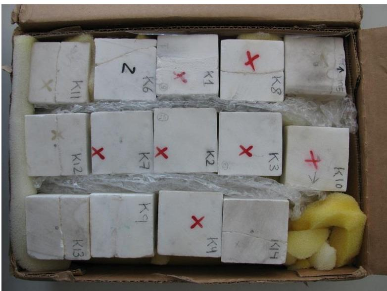
Abbildung 2: 14 Würfel ca. 4,5 cm Kantenlänge mit definierten Fehlstellen.
