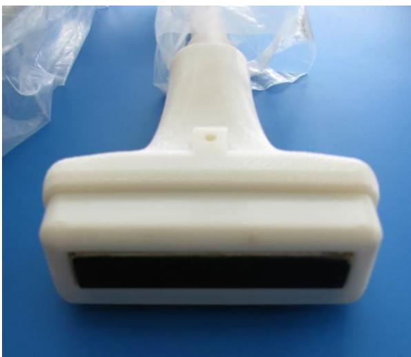
Abbildung 19: 64-elementiges Array mit einer Koppelschicht aus karbongefülltem Silikon.
