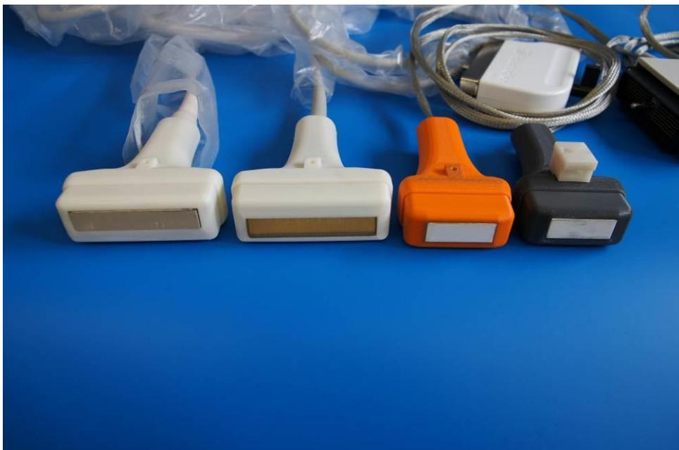
Abbildung 31: 64- und 32- elementige Phased Array-Messköpfe.
