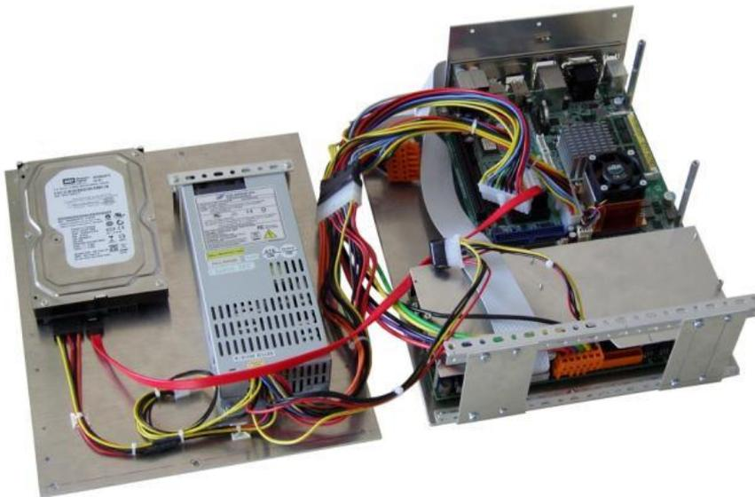
Abbildung 22: PC-Komponenten des DiPhAS Systems.
