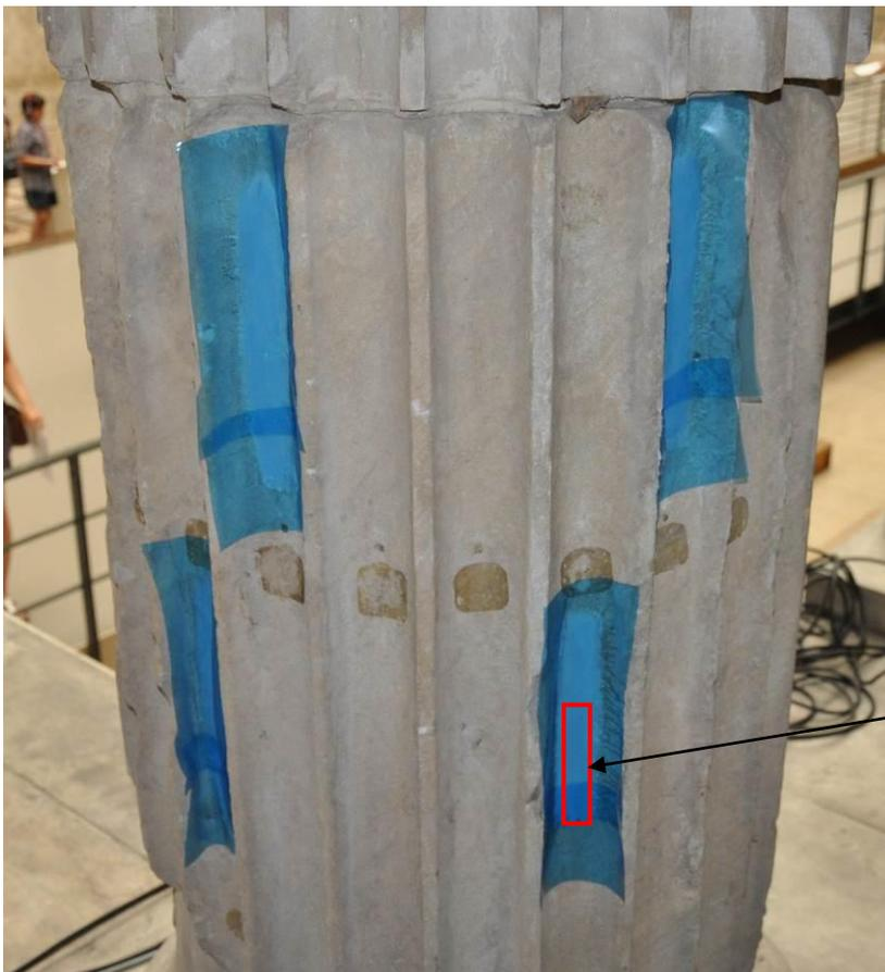
Abbildung 44: präparierte Bereiche auf der Rückseite einer Säule. Die Messung wurde im rot markierten Bereich durchgeführt.
