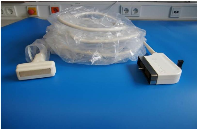
Abbildung 18: 64-elementiges Array mit einer PEEK Anpassungsschicht.
