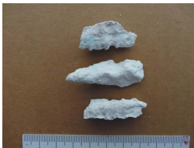
Abb. 10: Sinterproben zur Wasseraufnahmeprüfung
