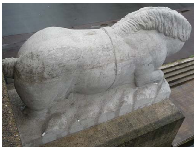
Abb. 21: Ein Farbwechsel markiert den vermuteten Übergang zwischen dichterem (unten) und offenporigem Bereich am Pferd.
