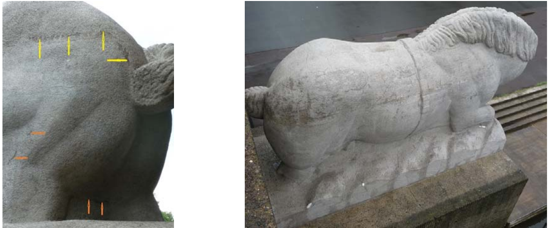
Abb. 4: links: gelbe Pfeile markieren offenporigen Bereich; rechts: dunkle Linie markiert Übergang zwischen dichtem und offenporigem Bereich am Pferd
