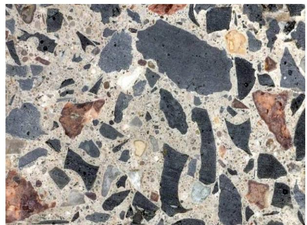
Abb. 92: Stamfbetongefüge, Anschliff, untere Bildkante entspricht 4 cm
