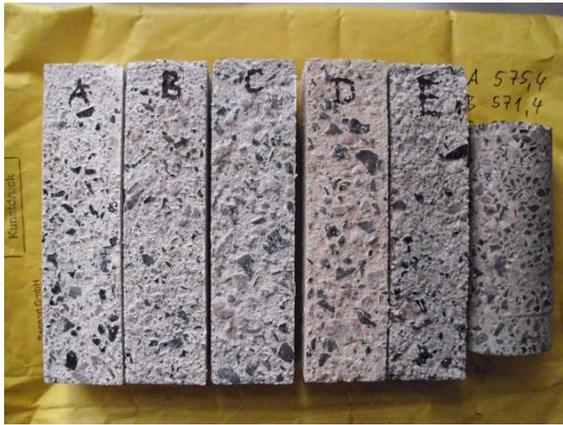
Abb. 96: Probekörper für die E-Modulmessungen und die Untersuchungen zur Wasseraufnahme
