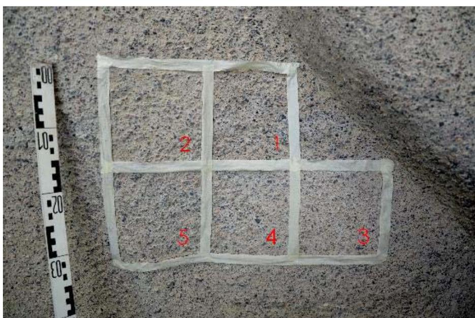
Abb. 142: Probeflächen mit verschiedenen Schlämmen, nachträglich gestrahlt
