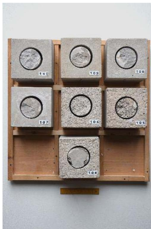
Abb. 110: Probekörper für Haftzugfestigkeit
