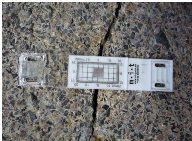
Abb. 33: Im Projekt verwendeter Rissmonitor
