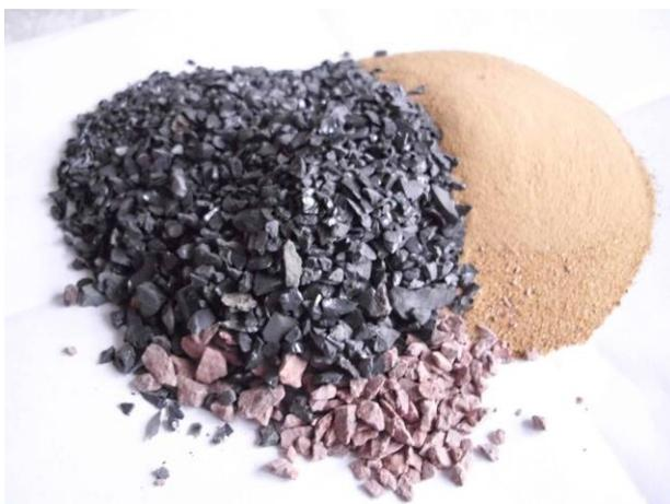
Abb.91: Zuschläge: Mansfelder Kupferschlacke, Porphyrsplitt, Quarzsand
