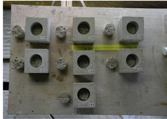
Abb. 97: Zweisteinproben, Probekörper für die Haftzuguntersuchungen
