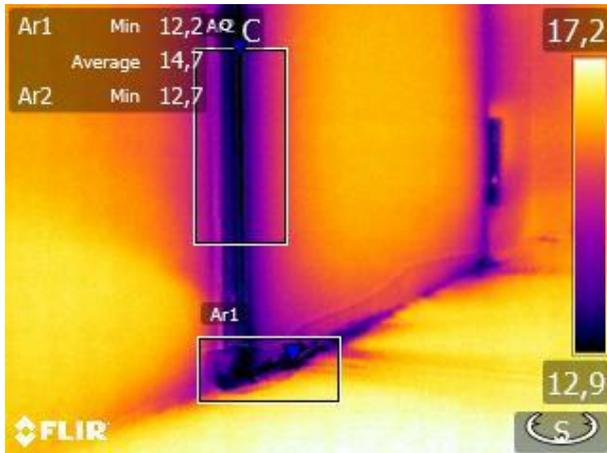
**Bild 17:** An der Tüрдichtung. **Unbedingt nachstellen!**
