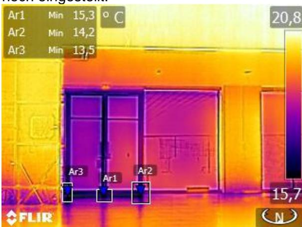
**Bild 9:** An der Türdichtung unten. Wird noch eingestellt.
