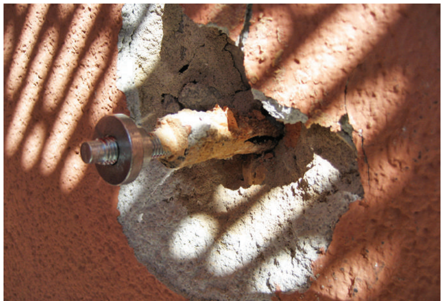
Abb. 41: Dübelauszugsversuche Aussenwand Bestand
