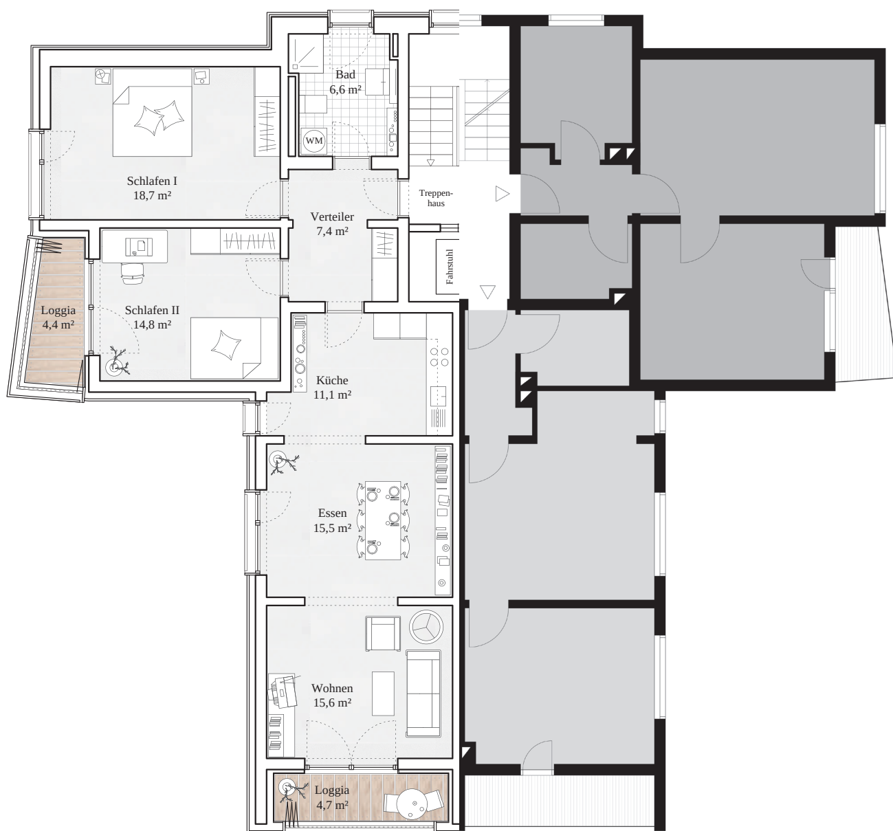
Abb. 12: Grundriss links Sanierung und rechts Bestand
