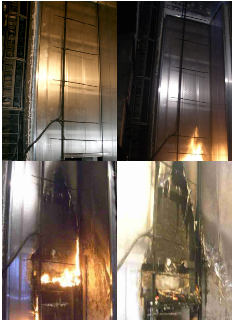
Abb. 40: Prüfaufbau (oben)/ Prüfminute(unten)
