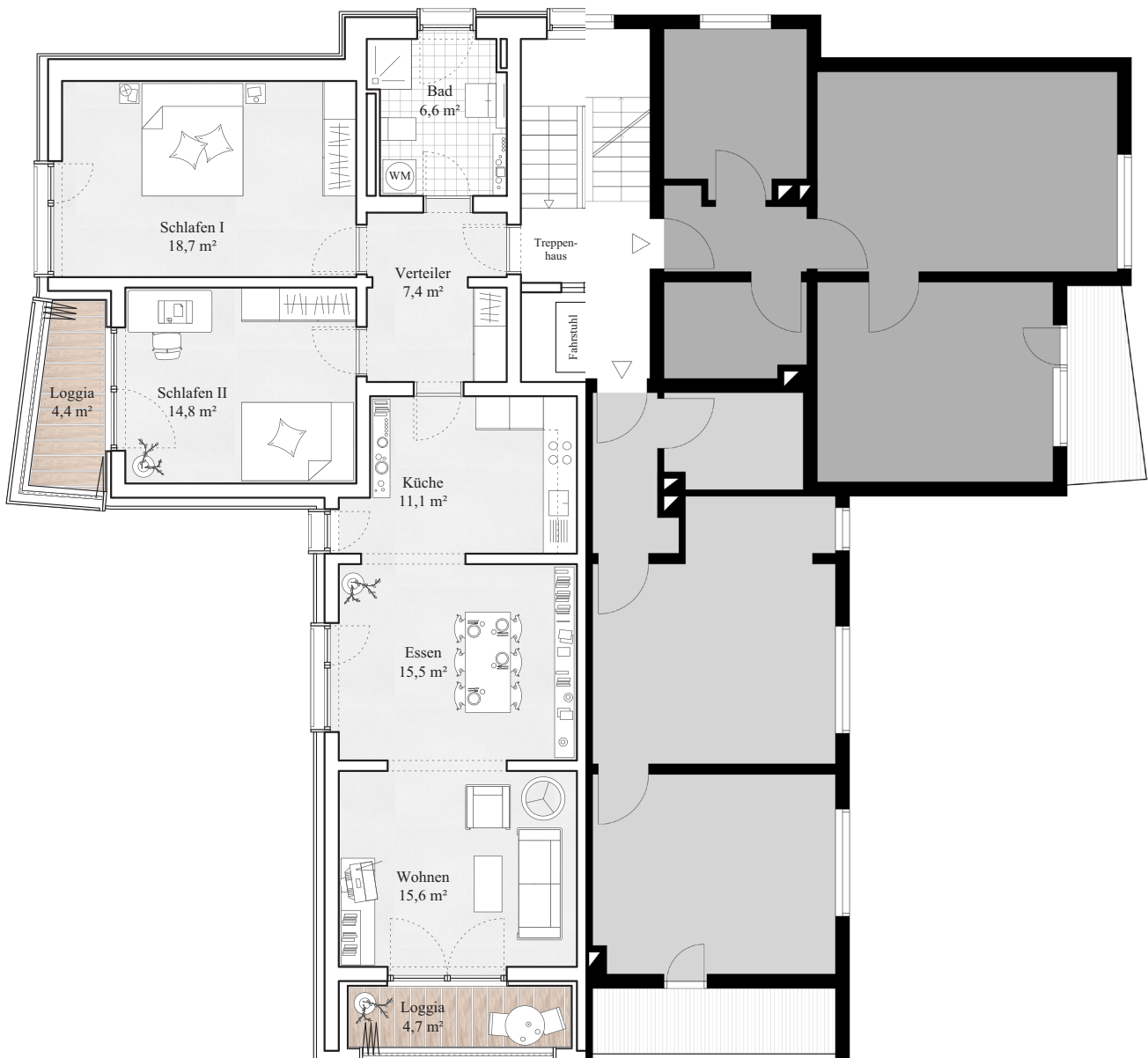
Abb. 12: Grundriss links Sanierung und rechts Bestand
