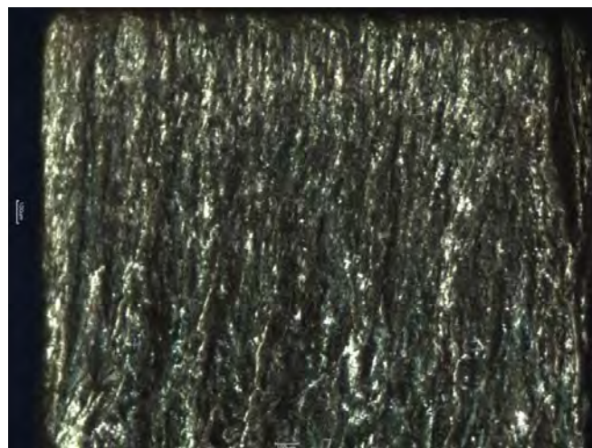
Abbildung 16: Schnittfläche eines Kupferquaders nach der Behandlung in Ameisensäure
