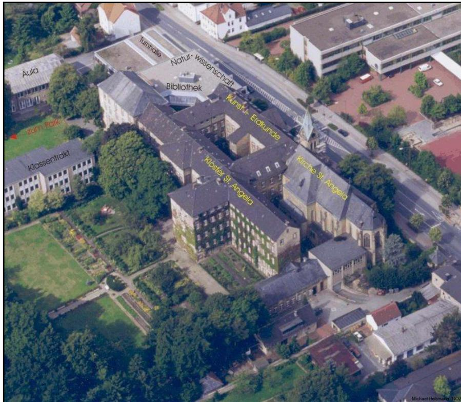
Der untersuchte Klassentrakt der Angelaschule wurde 1965 als Stahlbetonskelettbau mit einer Verblendschale aus Klinkern erbaut. Es handelt sich bei dem Flachdachgebäude um einen frei stehenden dreigeschossigen Baukörper in Nordwest-Südost-Ausrichtung. Er gliedert sich in drei gestaffelt angeordnete Gebäudeteile.
