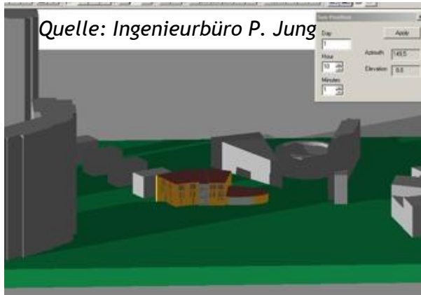
Abbildung 3 Verschattungssimulation im Rahmen der dynamischen Gebäudesimulation
