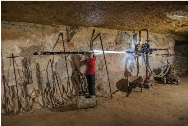
Abb. 6: Schausteinbruch Rinval des Vereins der Freunde des Steins (Les Amis de la Pierre). Die hydraulisch betriebenen Schrämmaschinen ersetzen größtenteils die anstrengende Handarbeit des Freilegens der Blöcke per Hand. Der Lichtstrahl erhellt den Schlitz, der mit der Maschine geschrämt wurde.
