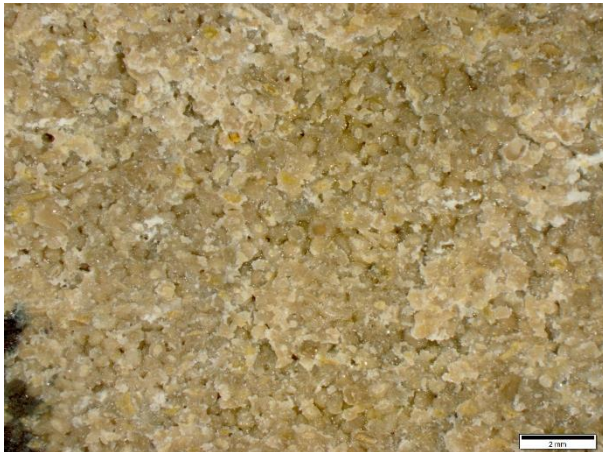
Abb. 10: Bereits im Lupenbild ist das dichtere Gefüge und das leichte bräunliche Durchscheinen der Komponenten beim Morley-Typ zu erkennen. Als optischer Ausdruck der Dolomitisierung treten die glitzernden Lichtreflexe der Dolomithomboeder auf.
