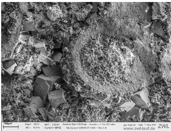
Abb. 11: Morley-Oolithe zeigen neben den wenig scharf abgegrenzten Ooiden immer Dolomithomboeder in den Ooid-Zwischenräumen. Diese können auch korrodiert und von einer jüngeren Calcit-Generation überwachsen sein. Probe M329-1.
