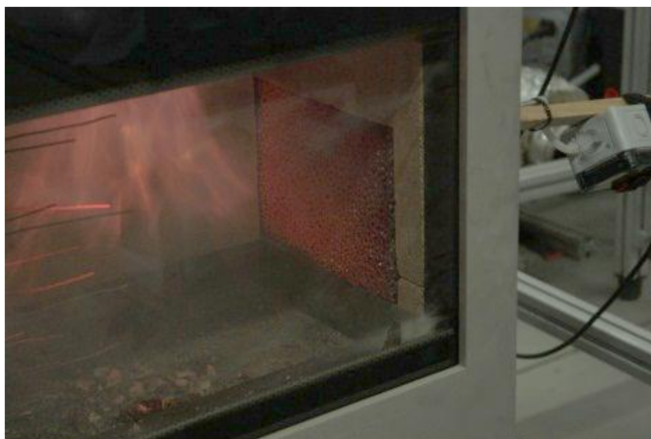
Abbildung 3.29: Fotografie des Versuchsaufbaus mit katalytisch aktivierten Schwämmen ( \text{MnO}_x/\text{Al}_2\text{O}_3 , Größe 2: 140 \times 200 \times 20 mm) im unteren Brennraum
