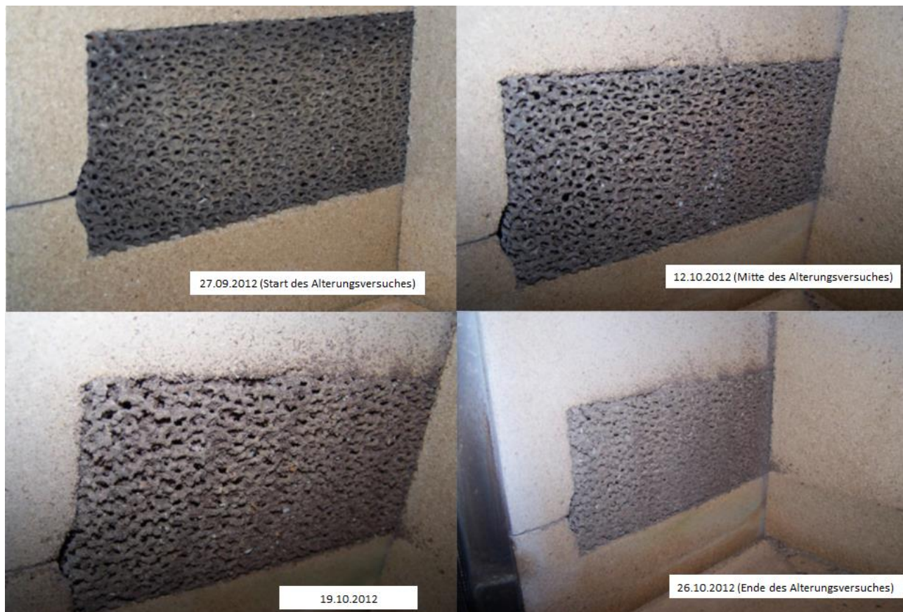
Abbildung 3.31: Ausgewählte Fotos der Wandkatalysatoren (Größe 1) bei der durchgeführten Alterung unter Praxisbedingungen (Vorführkaminofen) für ca. 185 h realer Betriebszeit
