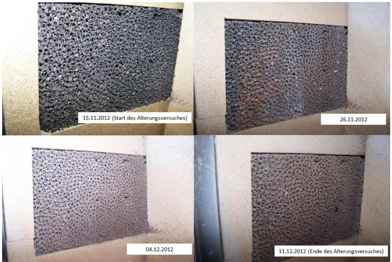
Abbildung 3.32: Ausgewählte Fotos der Wandkatalysatoren (Größe 2) bei der durchgeführten Alterung unter Praxisbedingungen (Vorfürkaminofen) für ca. 144 h realer Betriebszeit
