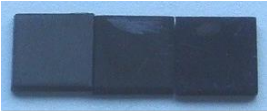
Abbildung 3.8: Proben des (von links) unbehandelten, einmal brünierten und dreifach brünierten TwinFire-Gate-Materials
