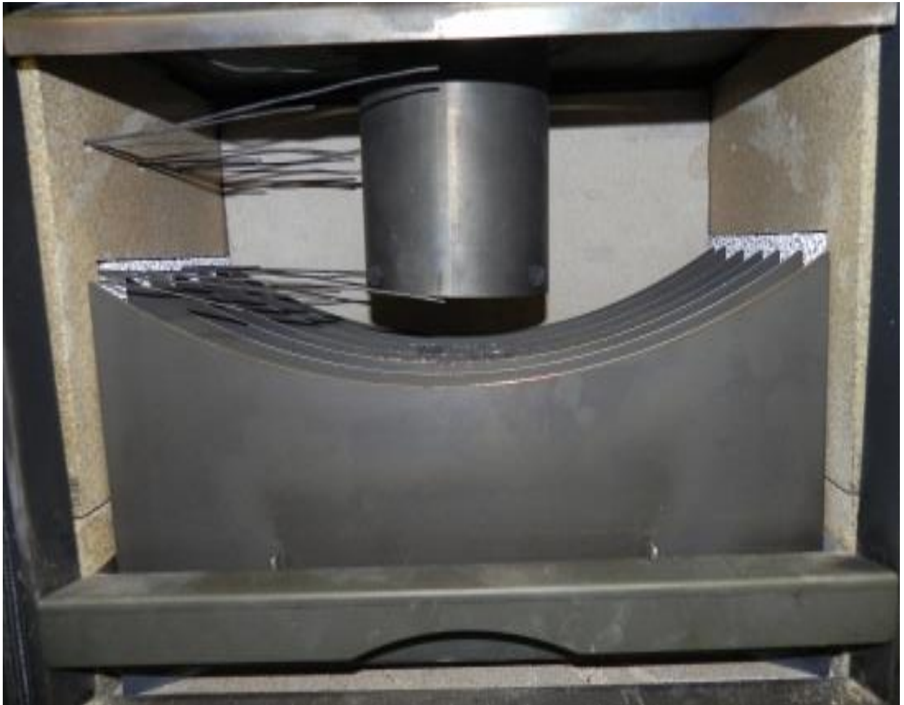
Abbildung 3.39: Fotografie des Versuchsaufbaus mit Edelstahlrohr und zylindrischem Keramikmonolith, dem modifizierten TwinFire-Gate (gleich großen Lamellen) im unteren Brennraum des Kaminofens und unbeschichteten Schwämmen der Größe 2: 140 x 200 x 20 mm
