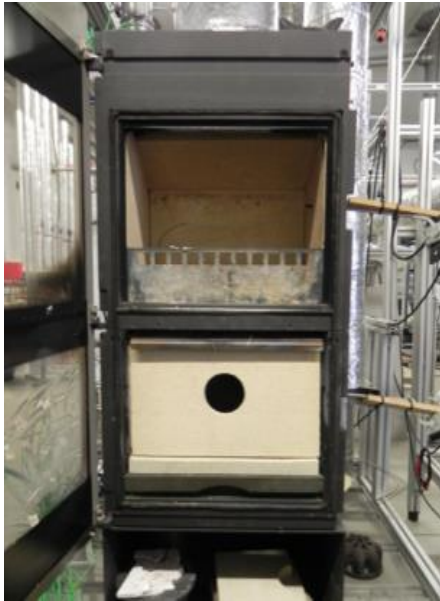
Abbildung 3.30: Fotografie des Versuchsaufbaus mit der Hitzerrückhalteplatte im unteren Brennraum
