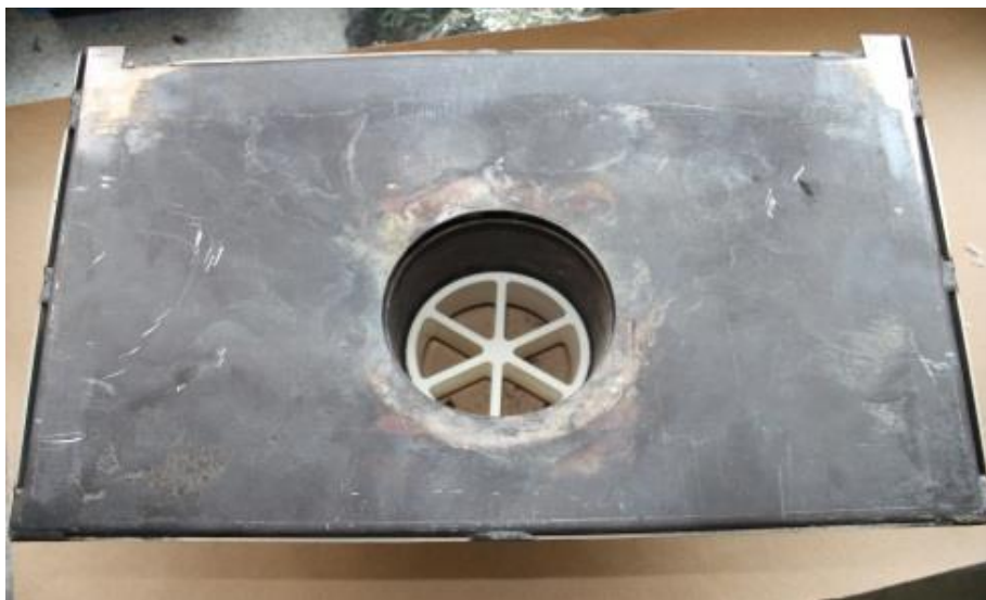
Abbildung 3.35: Fotografie des am Doppelboden befindlichen Edelstahlrohres mit installiertem und nach DBFZ-Vorgaben angefertigtem Monolithen der Firma Haldenwanger
