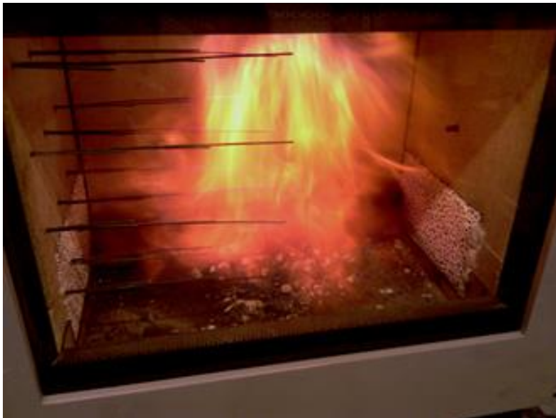
Abbildung 3.27: Fotografie des Versuchsaufbaus mit unbeschichteten \text{Al}_2\text{O}_3 -Schwämmen im unteren Brennraum
