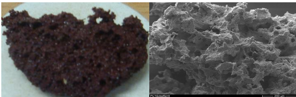
Abbildung 3.14: Probe aus Nickelferrit durch Aufschäumung von PU erhalten
