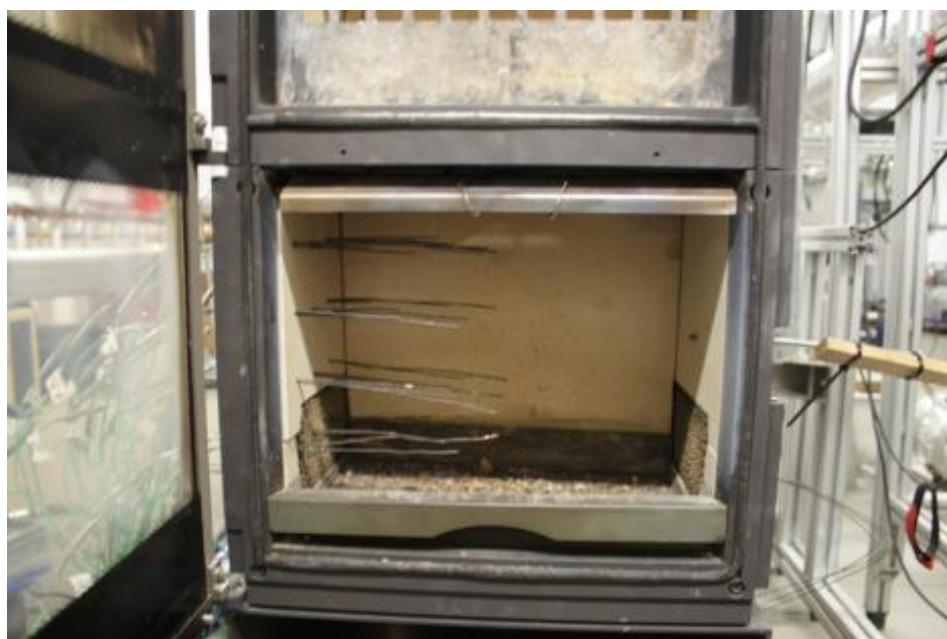
Abbildung 3.28: Fotografie des Versuchsaufbaus mit katalytisch aktivierten Schwämmen (MnO x /Al 2 O 3 , Größe 1: 90 × 200 × 20 mm) im unteren Brennraum
