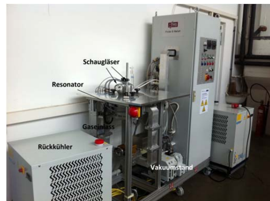
Abbildung 3.1 Schematische Darstellung und Foto der Versuchsanlage
