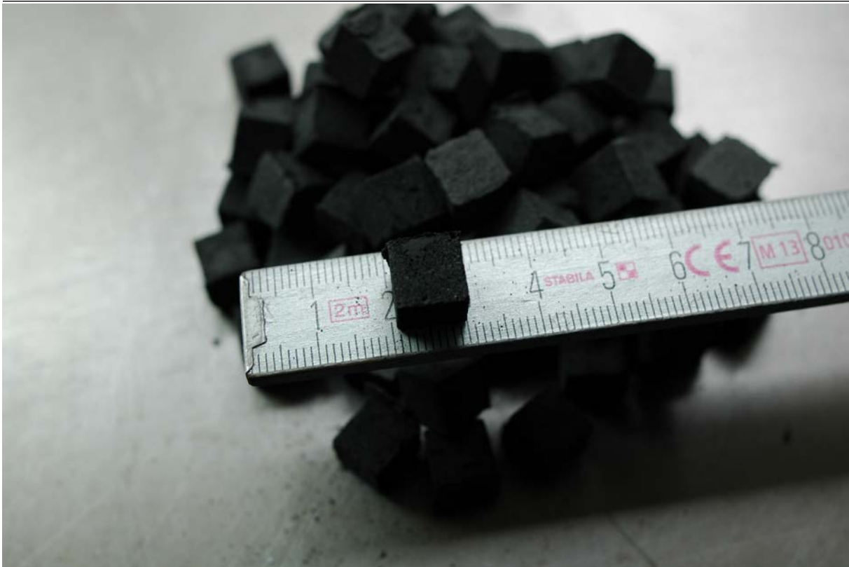
Abbildung 10: Fertige Pellets aus Quarz und Carbon Black mit Zucker als Bindemittel.
