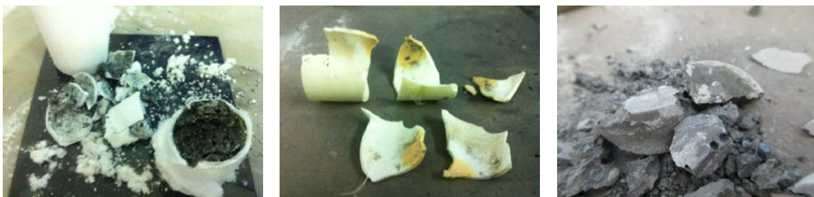
Abbildung 17: Zerstörte Oxid-Keramiken aus Aluminiumoxid (links), Zirkonoxid (Mitte) und Yttriumoxid (rechts).
