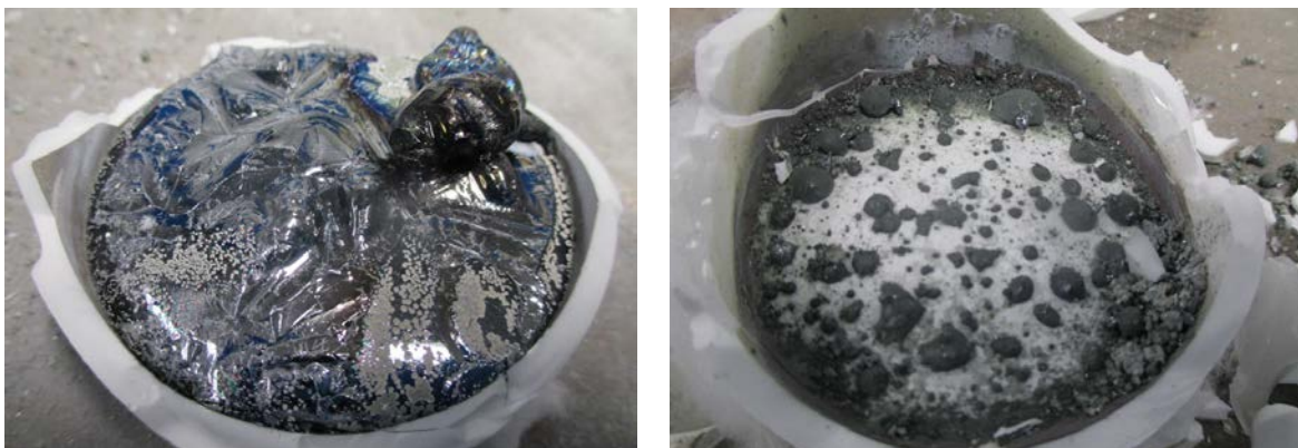
Abbildung 20: Hohe (links) und niedrige (rechts) Ausbeute an gefiltertem Silizium beim Einsatz verschiedener Filter im Mikrowellenofen.
