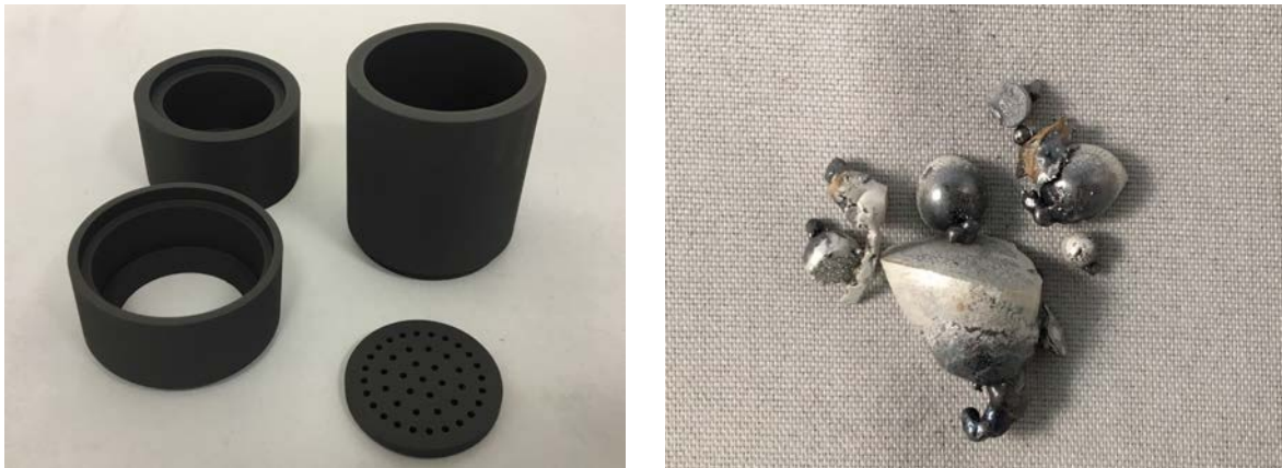
Abbildung 18: Mit Graphitspray beschichteter Bornitridtiegel (links) und das gewonnene Silizium mit deutlichen, weißen Anhaftungen von Bornitrid (rechts).
