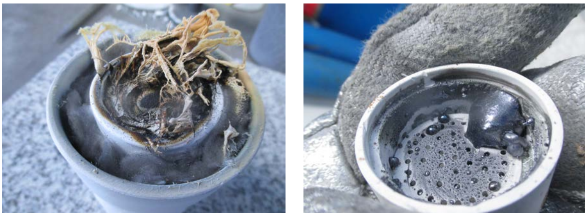
Abbildung 11: SiO 2 -Kondensat auf der Tiegeloberfläche (links) und entstandenes Silizium (rechts).
