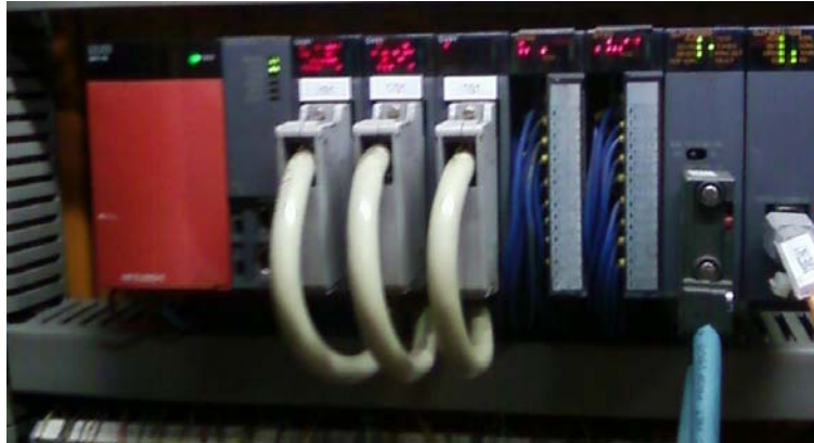
Abbildung 8: Steuerung der Abfüllmaschine mit Ethernet Anbindung ans Informationssystem (siehe Pfeil)
