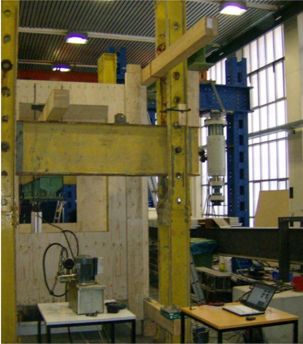
Abb. 4 Versuchsaufbau Belastungsprüfung Holzbalkon
