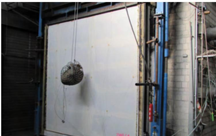
Abb. 9 Überprüfung der mechan. Beanspruchbarkeit der Massivholzwand nach einer Brandbeanspruchungsdauer von 90 Minuten
