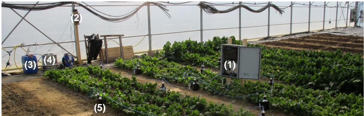
Abbildung 24: Versuchsaufbau im Gewächshaus mit Messkomponente (1), Düngekomponente (2), Düngebehälter (3), Vakuumbehälter für Saugkerzen (4), Sammelflaschen für Saugkerzen (5).
