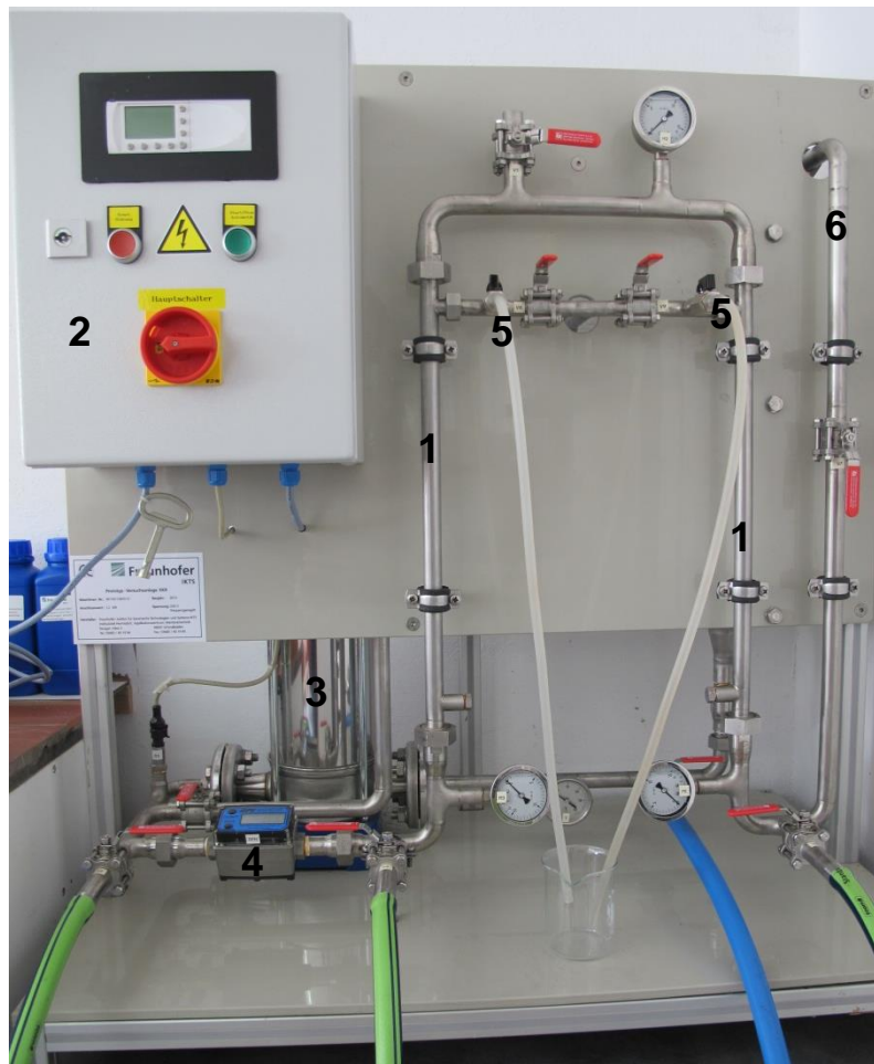
Abbildung 20: Nanofiltrationsanlage, die vom IKTS für den Labormaßstab angefertigt wurde und zur Entfernung von Nitrat aus Bodenlösung eingesetzt wird. 1 Membranen, 2 Steuerung, 3 Pumpe, 4 Durchflussmesser, 5 Permeatausfluss, 6 Rückführung des Konzentrats in den Kreislaufbehälter (befindet sich hinter der Montageplatte).
