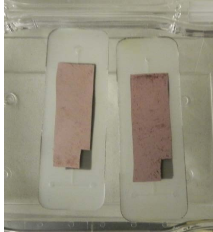
Abbildung 21: Mikroglass-Reaktor als Glasscheibe ausgeführt mit Kontaktierungen
