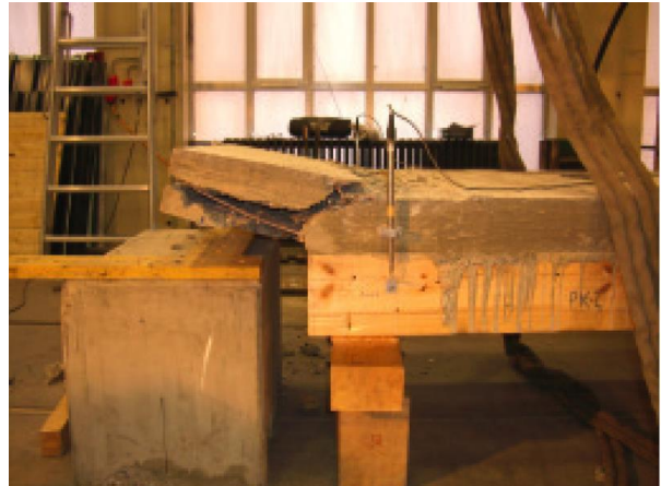
Abb. 831 u. Abb.832: Prüfkörper für Holz-Beton-Verbunddecke mit Deckenauflegerkonsole [8][33]
