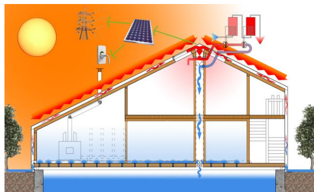
Abb. 26: Energiekonzept Haus im Haus mit Glashülle [54]
