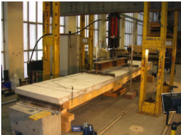
Abb. 831 u. Abb.832: Prüfkörper für Holz-Beton-Verbunddecke mit Deckenauflegerkonsole [8][33]
