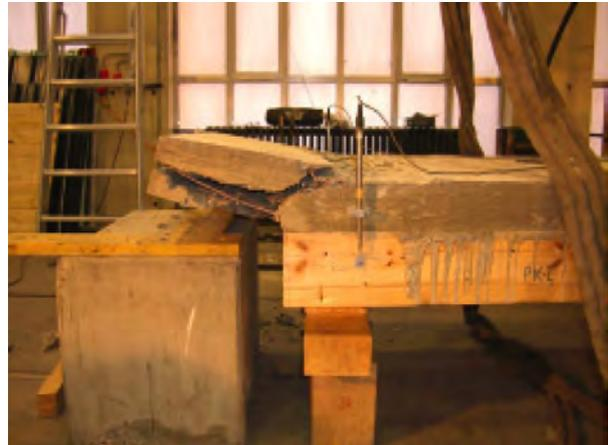
Abb. 831 u. Abb.832: Prüfkörper für Holz-Beton-Verbunddecke mit Deckenauflegerkonsole [8][33 ]
