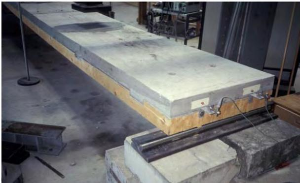
Abb. 18: Holz-Beton-Verbund Versuchskörper [54]
