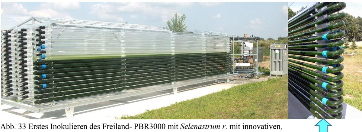
Abb. 33 Erstes Inokulieren des Freiland- PBR3000 mit *Selenastrum r.* mit innovativen, reversiblen Glasrohrverbindungen
