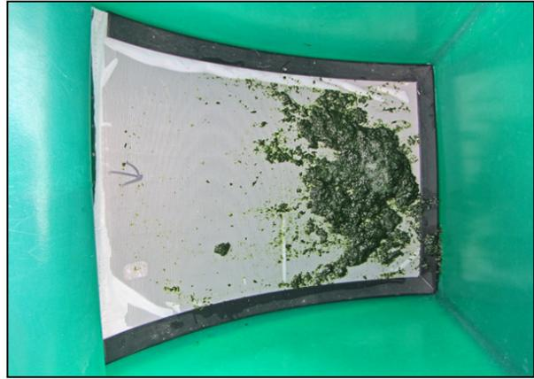
Abb. 49 Feststoff auf Bogensieb mit zusätzlichem 25 µm Filtertuch
