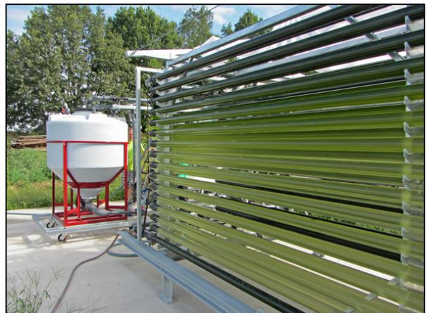
Abb. 39 PBR3000 nach Ernte und Auffüllung mit nährstoffreichem Kreislaufwasser
