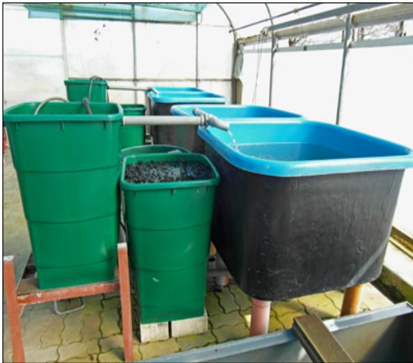
Abb. 2 Aquakulturkreislaufanlage mit 2 separaten Modulen
