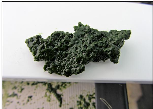
Abb. 51 Detailansicht Feststoff nach Bogensiebung mit zusätzlichem 25 µm Filtertuch
