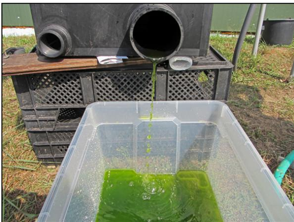
Abb. 52 Siebung ohne Flockungsmittel; Ansicht Filtrat nach Siebung
