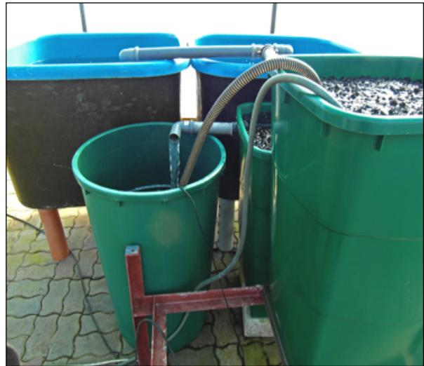
Abb. 3 Modul bestehend aus 2 Fischbecken, Sedimentationsstufe und Belüftungsbecken
