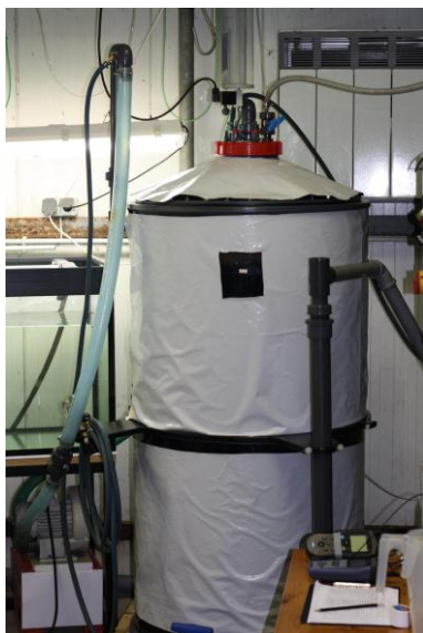
Abb. 2a: selbstreinigender Innertgas Denitrifikations-Reaktor (SID-Reaktor) im halbtechnischen Maßstab ( 0,65 \text{ m}^3 Reaktorvolumen); 2b: Verschlussdeckel mit Zu- und Abgängen.
