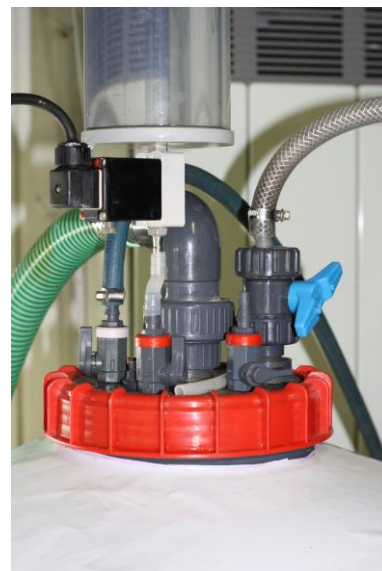
Abb. 2a: selbstreinigender Innertgas Denitrifikations-Reaktor (SID-Reaktor) im halbtechnischen Maßstab ( 0,65 \text{ m}^3 Reaktorvolumen); 2b: Verschlussdeckel mit Zu- und Abgängen.
