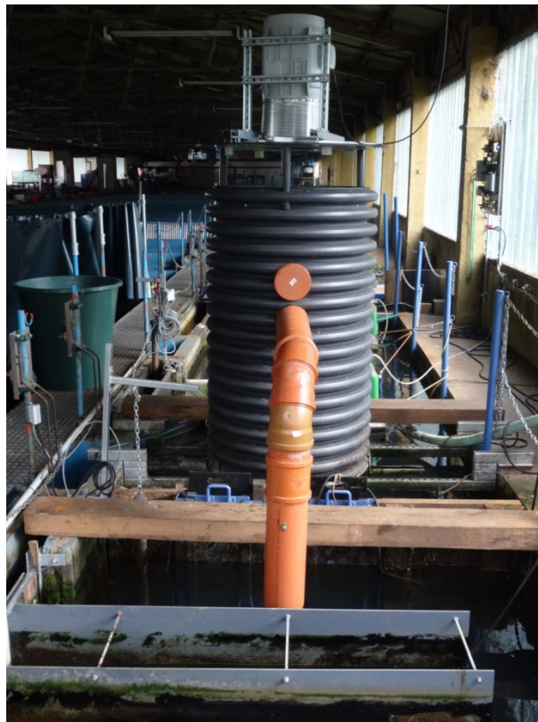
Abb. A2.10: CO 2 -Entgasungskolonne mit Lüfter
