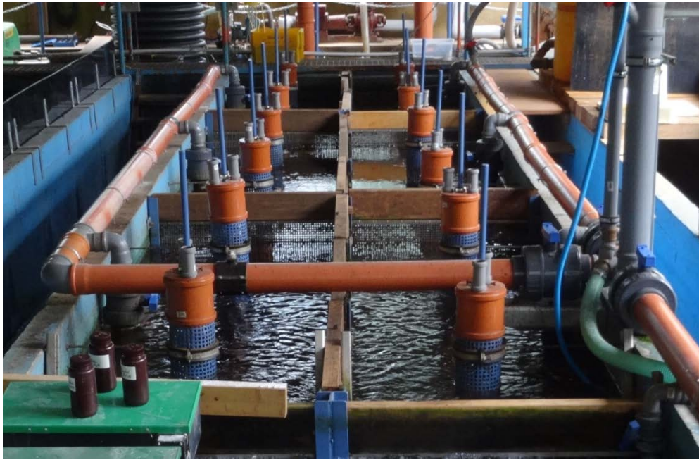
Abb. A2.7: getauchter Festbettfilter bestehend aus sechs Abteilen
