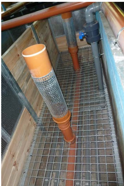
Abb. A2.8: getauchter Festbettfilter, links: Auflagegitter für die Füllkörper mit darunter liegenden Druckluftleitungen und Reinigungswasserabflüsse für das Rückspülen des Filters, Mitte: Expansion des Betts und Lösung der Feststoffe durch Drucklufteinpeisung, rechts: Ablauf des Reinigungswassers bei angehobenen Verschlussstopfen der Reinigungswasserabflüsse
