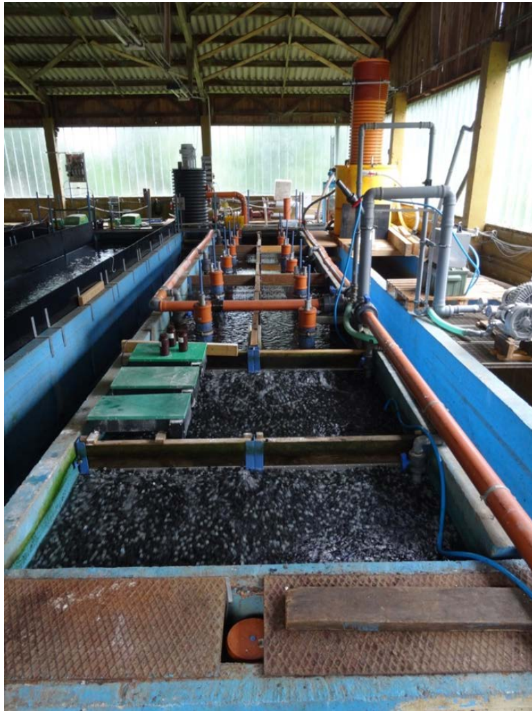
Abb. A2.5: „Biofilterrinne“ (vorn Schwebbetfilter, dahinter getauchter Festbetfilter bestehend aus sechs Segmenten, rechts Gebläse, rechts hinten Enteisenung, Mitte hinten CO 2 -Entgasungskaskade, links hinten schwimmende Sauerstoff-Niederdruckbegaser)
