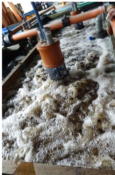
Abb. A2.8: getauchter Festbettfilter, links: Auflagegitter für die Füllkörper mit darunter liegenden Druckluftleitungen und Reinigungswasserabflüsse für das Rückspülen des Filters, Mitte: Expansion des Betts und Lösung der Feststoffe durch Drucklufteinpeisung, rechts: Ablauf des Reinigungswassers bei angehobenen Verschlussstopfen der Reinigungswasserabflüsse
