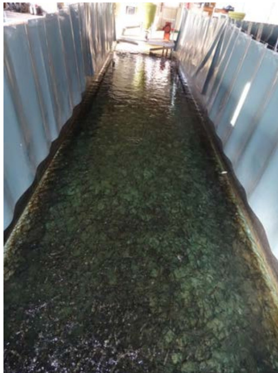
Abb. A2.2: Fischhaltungsrinne mit seitlichen Vorhängen aus PVC-Planen
