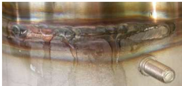
Bild 3: Versagen einer Schweißnaht im Dauerbetrieb
