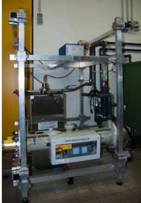
Bild 2: Ultraschall-Wirbelreaktor und separate UV-C-Einheit – aufgebaut im IGB/Berlin
