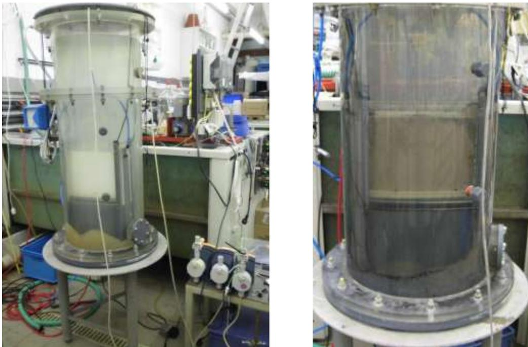
**Abb. 23: Versuch Erzeugung von Biofilm. Li: Start, Re: n. 8 d ohne Granulatrezirkulation**
