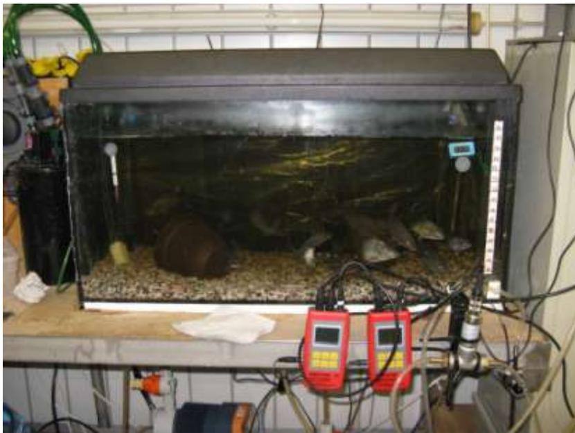
**Abb. 19: Becken 3 (AQ 3) mit Karpfen (hinten u. seitlich schwarze Folien als Lichtschutz), Re v. Becken: Membran-Deni-Reaktor, li: Nitrifikationsreaktor**
