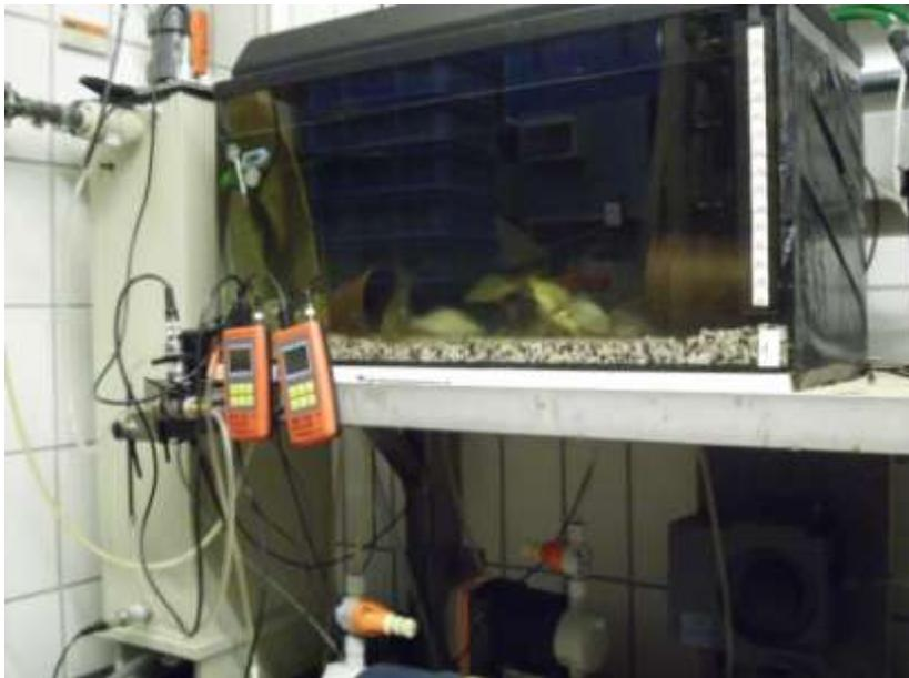
**Abb. 17: Becken 1 (AQ 1) mit Karpfen (hinten u. seitlich schwarze Folien als Lichtschutz), li v. Becken: Membran-Deni-Reaktor, unten: Permeat u. Messpumpe**
