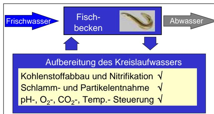
**Abb. 1: Vereinfachtes Schema einer modernen Aquakultur-Kreislaufanlage**
