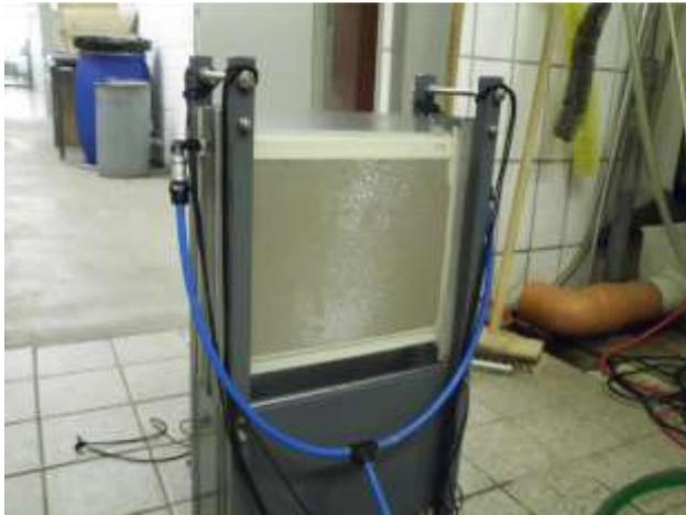
**Abb. 24: Versuch mit Biofilm 5 min n. Start der Granulat-rezirkulation: grau-braune Fläche: Biofilm; weiße Stellen: gereinigte Membran**
