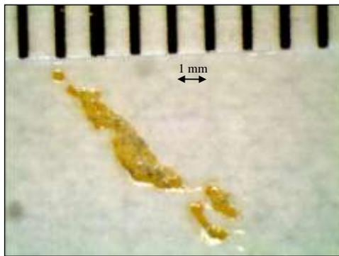
**Abb. 21: Schäden an Membranen, hier nach Abrasionstest durch Elastollan 1180A - (Stereolupe)**
