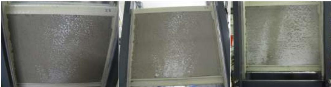
**Abb. 25: Vergleich 5 min (Li), 16 min (Mi) und 24 h (Re) n. Start der Granulat-Rezirkulation. grau-braune Fläche: Biofilm; weiße Stellen: gereinigte Membran**
